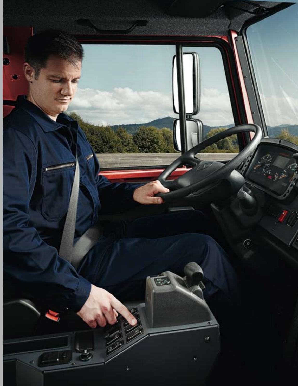
**Entspannt arbeiten – auch bei langen Einsätzen.** Die Kabine mit großzügiger Kopf- und Bewegungsfreiheit ist aus korrosionsfreiem, geräusch- und wärmedämmendem Hightech-Faserverbundwerkstoff (FVW) gefertigt. Sie besitzt eine sehr hohe Festigkeit und Steifigkeit und ist sowohl gefedert als auch gedämpft gelagert. Die überwiegend elektrische Steuerung der Funktionen reduziert Schwingungen in der Kabine auf ein Minimum.
