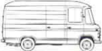
Fourgonnette avec 4 portes pivotantes et porte de chargement coulissante latérale
