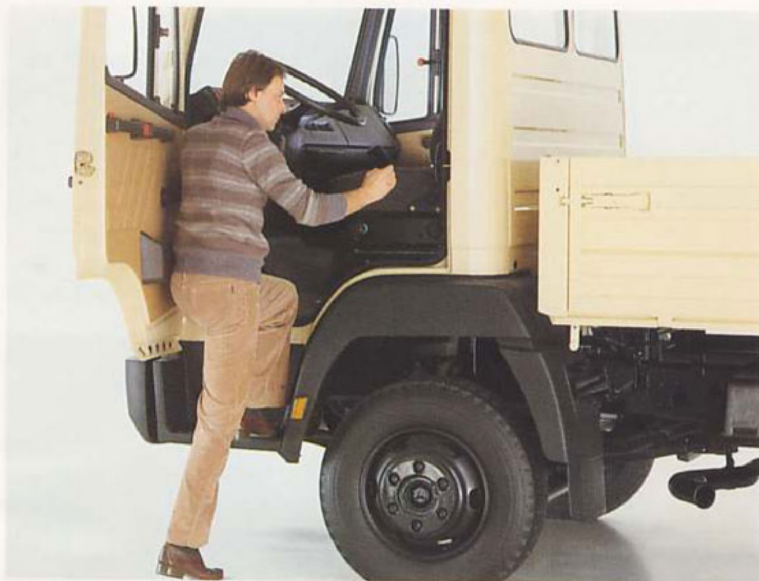
De brede trede voor de vooras zorgt voor probleemloos instappen, mede dankzij de ideale hoogte.
