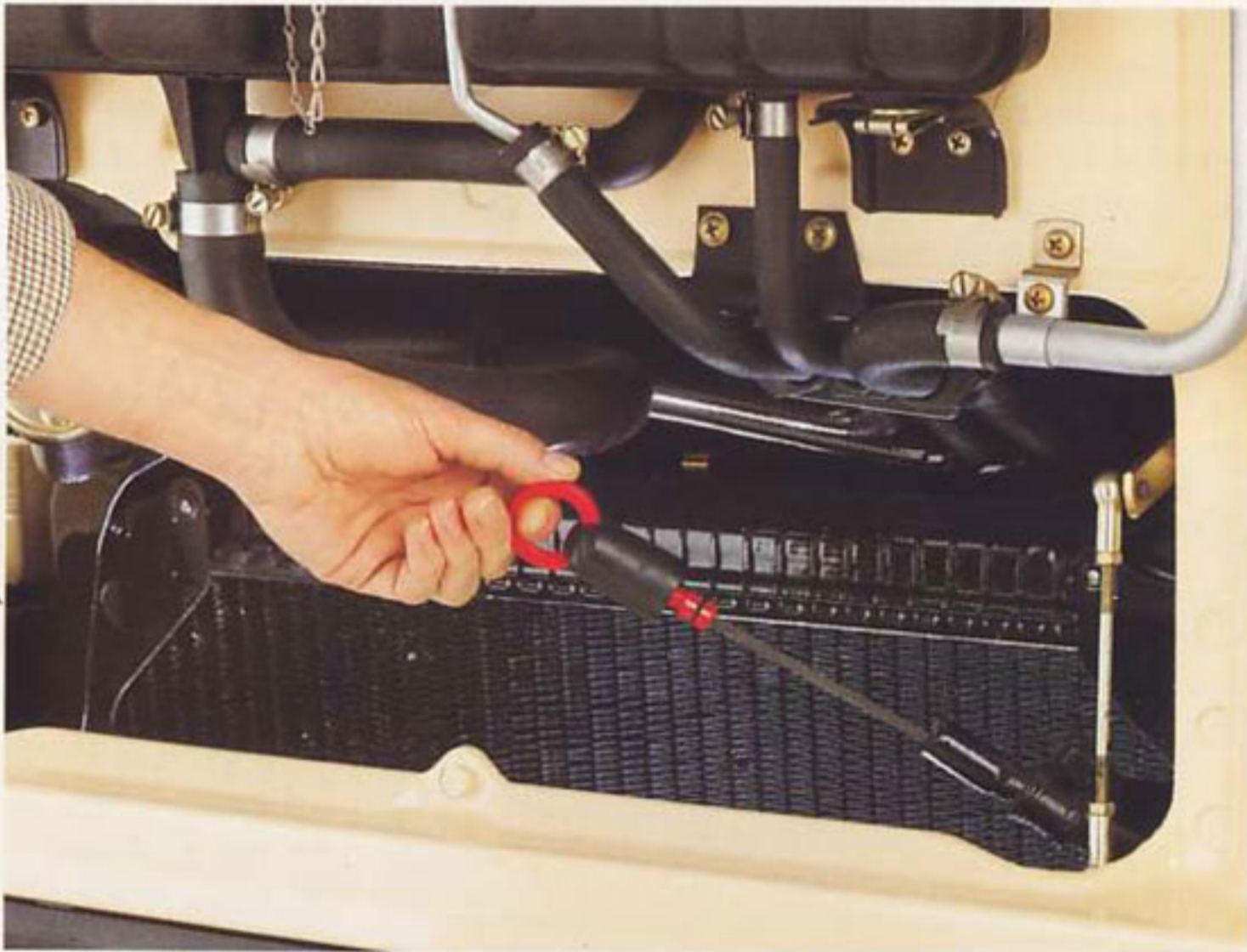
Kontrole van het oliepeil – makkelijk en geen vuile handen.
