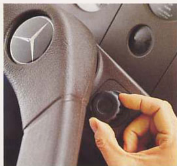
Een voorbeeld van bedieningsgemak: vanaf de bestuurdersplaats kan het stationair toerental worden geregeld.
