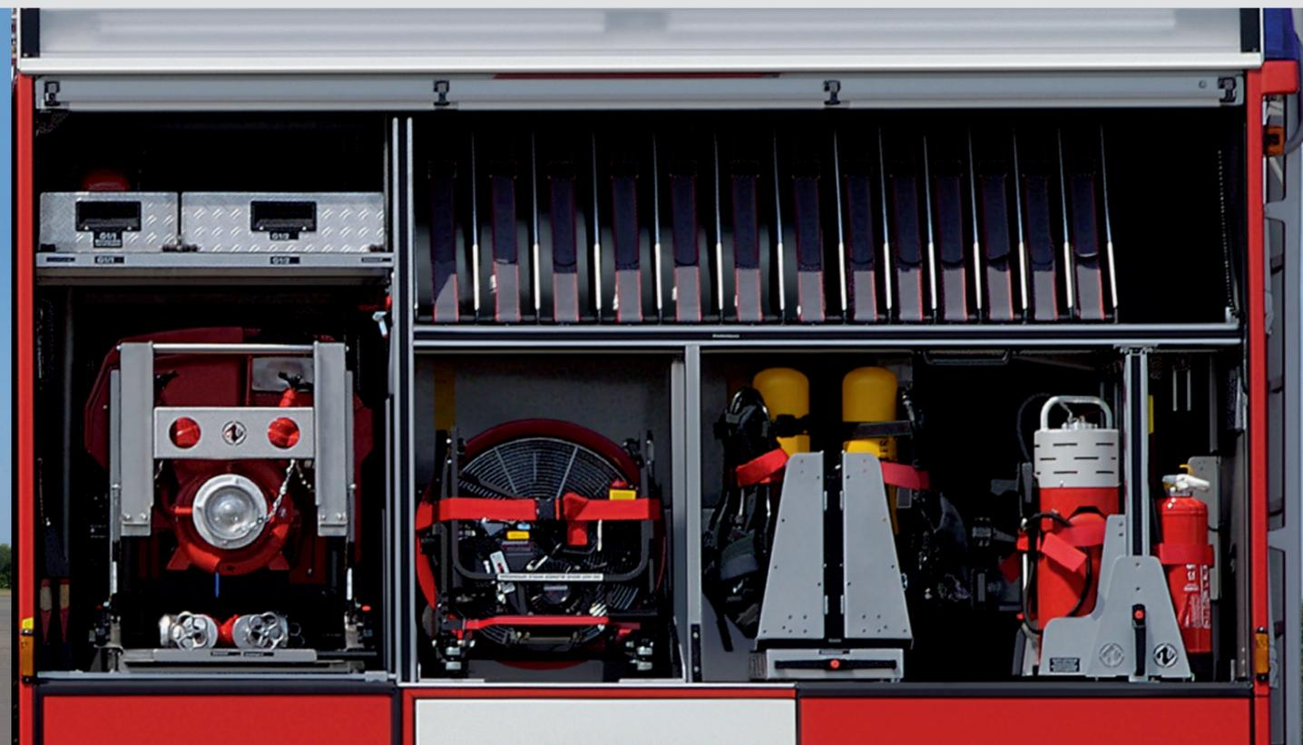
▲ Für alle Einsätze gerüstet: Der stabile Rahmen mit 50-mm-Lochbild-Raster ermöglicht schnelle und kostengünstige An- und Aufbauten. Und das ganz ohne Bohrungen – der Korrosionsschutz der kathodischen Tauchgrundierung bleibt so erhalten.
