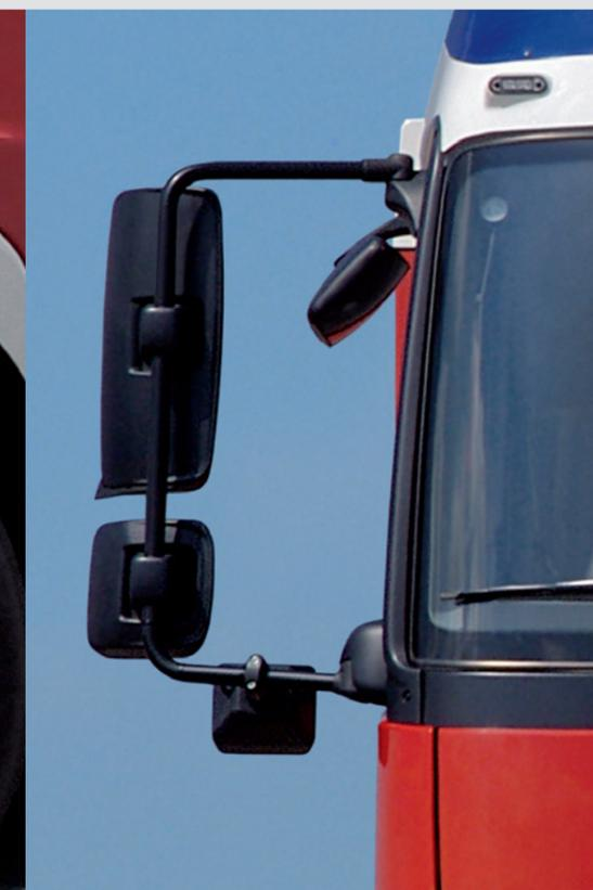
▲ Großflächig und manuell beheizbar bieten die Rückspiegel immer beste Rundumsicht auf der Fahrt zum Einsatzort. Die unten angebrachten Weitwinkel-Außenspiegel und der Weitwinkel-Zusatzspiegel minimieren den toten Winkel.
