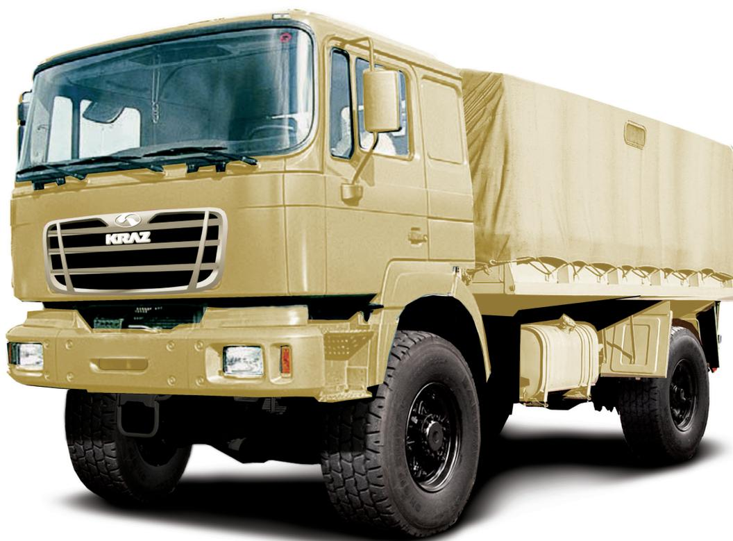
**Бортовой автомобиль КрАЗ В6.2МЕХ** повышенной проходимости предназначен для перевозки различных грузов и людей, буксировки транспортных и специальных прицепов, а также самолётов на аэродромах и эксплуатации по дорогам всех категорий и бездорожью.
