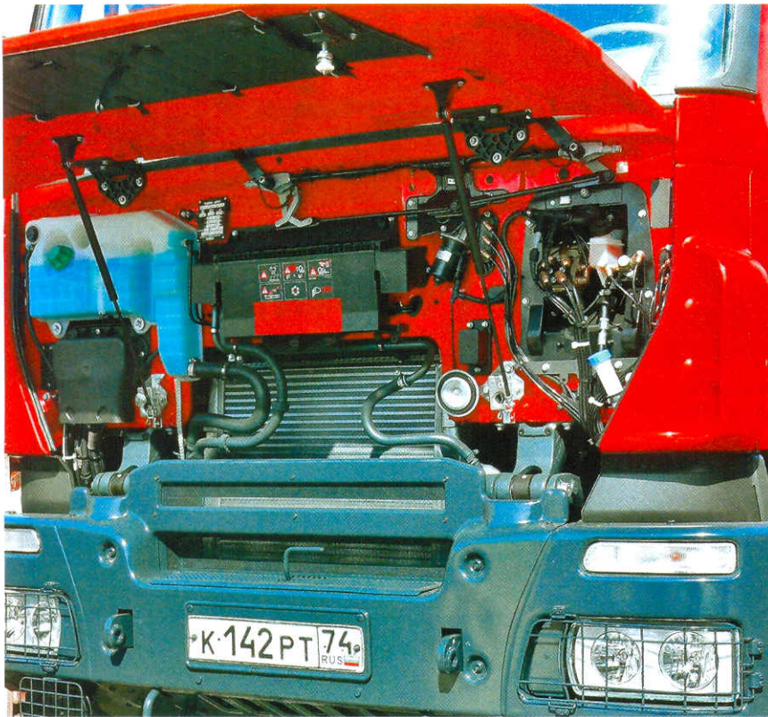
У IVECO Trakker образцовая, для самосвала, конструкция «фасада»: трехэлементный стальной бампер, удобные буксирные крюки, решетки на фарах
