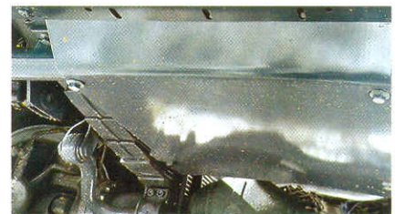
Радиатор снизу прикрыт толстым стальным листом
