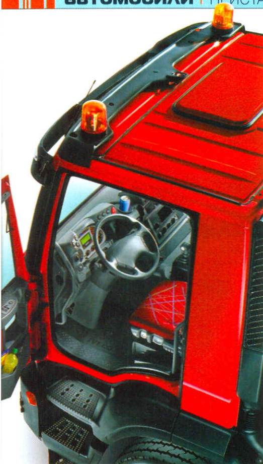
В отделке кабины «УралТраккер» ничем не отличается от европейских моделей, но комбинация приборов без цветного жидкокристаллического дисплея
