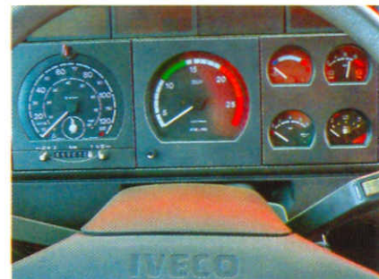
Комбинация приборов может быть дополнена тахографом
