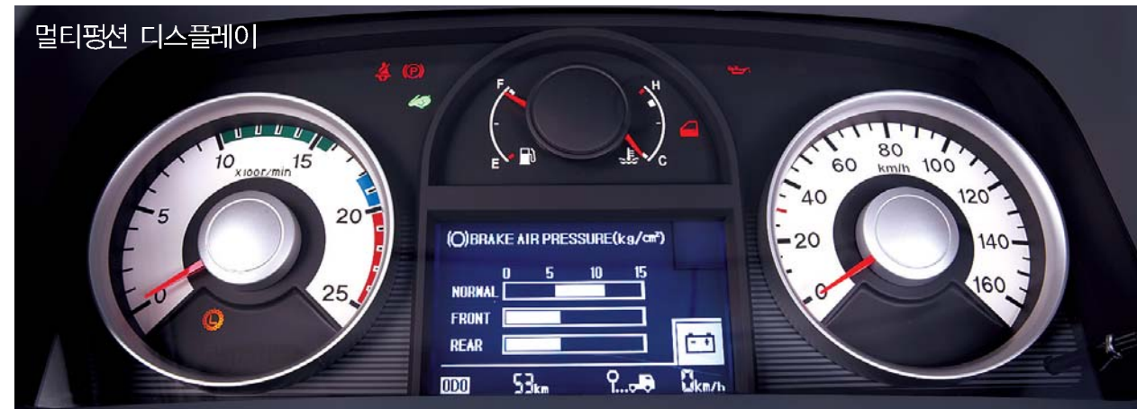
GOLD트림에 멀티펄선 디스플레이가 기본 적용되어 주행정보, 고장판단, 속도, 각종 게이지 등 정보표시가 가능하여 운전 편의성이 향상되었습니다. (*속하중은 에어서스펜션 차량에서만 표시 됩니다.)
