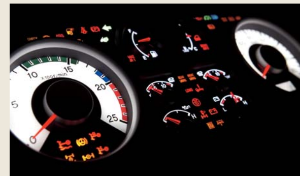
항공기 타입 중앙집중식 계기판 최첨단 디자인의 항공기 타입 중앙집중식 계기판은 LED조명을 적용하여 시인성 및 조작가능성이 향상 되었습니다.
