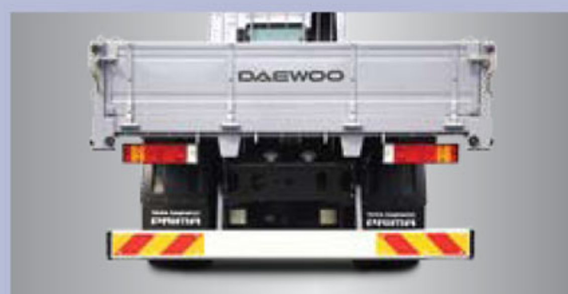
알루미늄 리어 프로텍터: 가볍고 고급스러운 느낌의 알루미늄 재질로 후면의 차량으로부터 안전성을 확보
