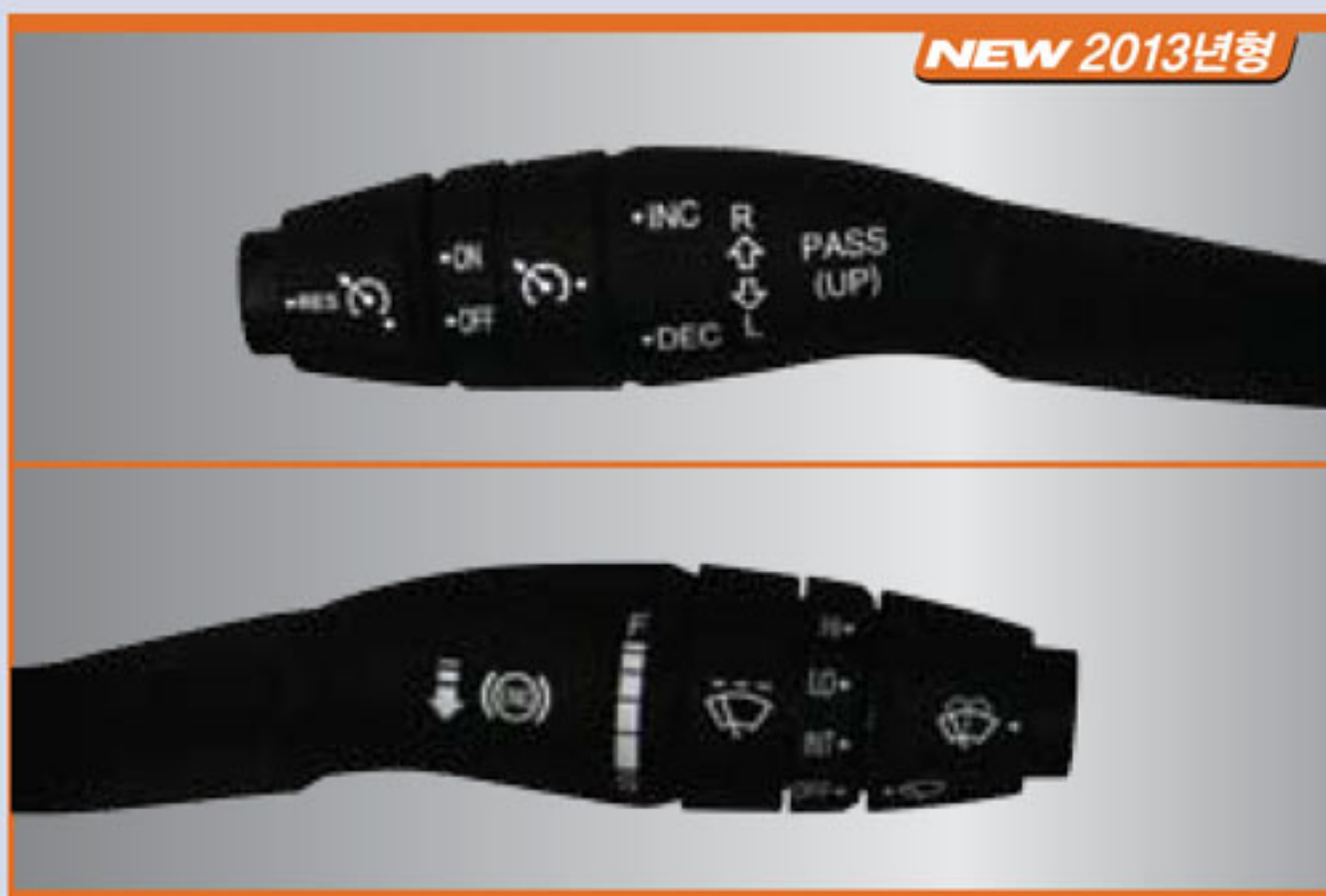
콤비네이션 레버 스위치 : 보조브레이크 스위치가 콤비네이션 레버에 내장되어 조작이 편리함 (방향지시등에 원터치 트리플 기능 적용)
