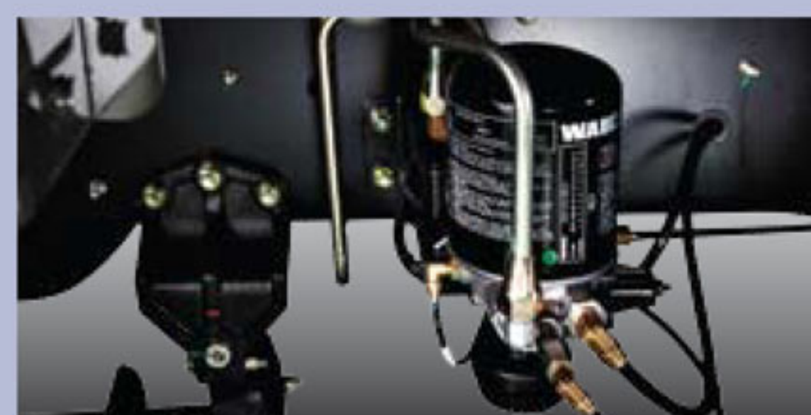
에어 드라이어 & 오일 세퍼레이터: 브레이크 라인에 발생하는 수분 및 이물질 제거하여 안정성을 높임
