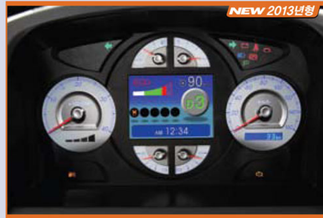
대형 컬러 LCD 계기판 : 차량 주행 정보를 모두 표시해 주어 차량의 경제적인 운행을 가능하게 함 (에코드라이빙 시스템 / 디지털시계 적용)
