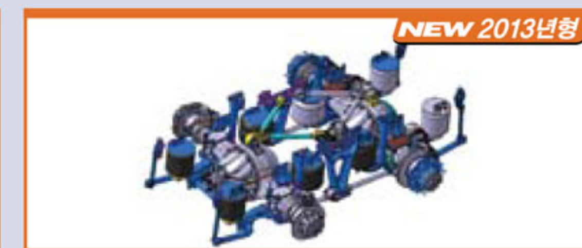
4 Bag 에어 서스펜션(후축): 4 Bag 에어 서스펜션은 최상의 승차감을 제공할 뿐만 아니라 내구성이 뛰어나며 진동을 최소화하여 화물보호에 최적화 되어있고 높이 기능 조절이 240mm로 경쟁사 대비 커서 화물 하역등에 큰 장점 (10X4 카고 선택사양)
