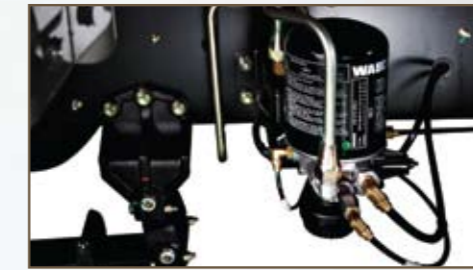
에어 드라이어 & 오일 세퍼레이터 : 수분 및 이물질 제거하여 브레이크의 안전성을 높였음
