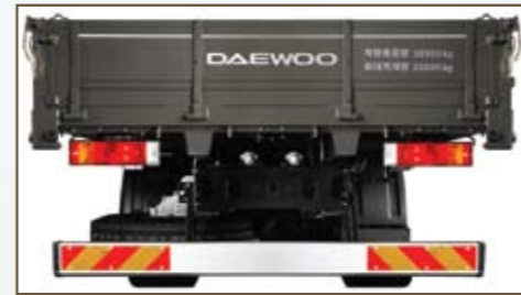
알루미늄 프로텍터 : 후면의 차량으로부터 안전성을 확보함은 물론 무게를 경량화한 알루미늄
