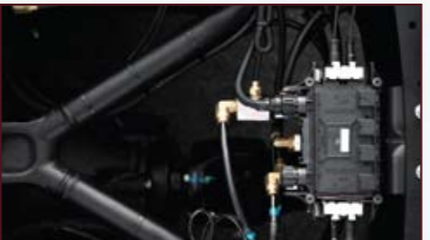
A ARM 토크로드 적용 : 수평하중이 좌우로 분산되는 성능이 뛰어난 A ARM 토크로드를 적용하여 선회시 안정성이 향상 되었음
