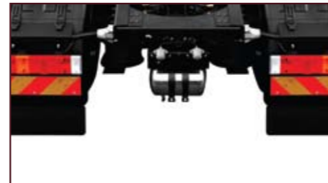
리어 리플렉터 : 후면의 차량으로부터 안전성을 확보하기 위하여 시인성을 보강한 리플렉터
