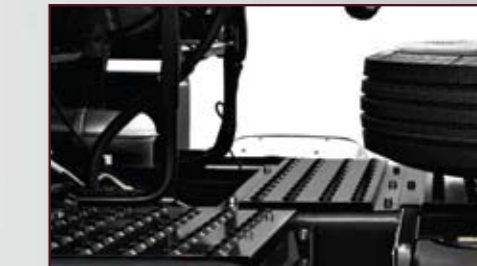
이동식 워킹 플레이트 : 프레임과 체결된 볼트 위치를 조절하여 워킹 플레이트를 원하는 위치로 조절 가능
