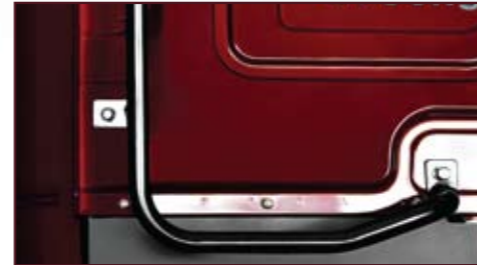
캡후면 손잡이 : 트랙터 후면 작업시 승,하강이 용이하도록 설치된 후면 손잡이
