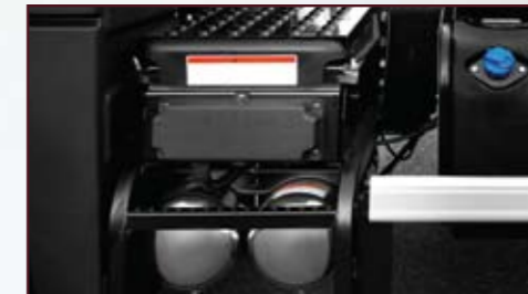
사이드 스텝 : 배터리 박스 상부에 발판을 적용, 하단에는 스텝을 배치하여 승,하강시 편의성 증대
