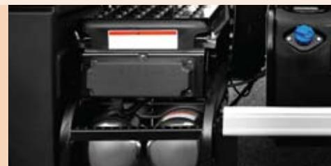
**사이드 스텝**: 배터리 박스 상부에 발판을 적용, 하단에는 스텝을 배치하여 승, 하강시 편의성 증대 (230A 배터리 옵션 사양)
