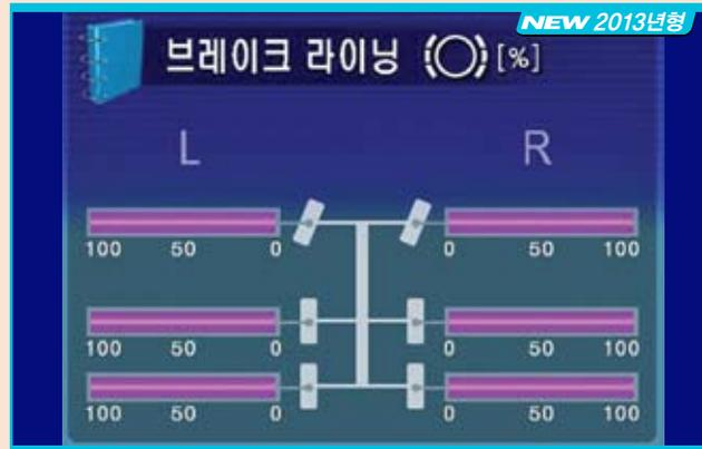
**브레이크 라이닝 모니터링 시스템**: 운행시 모든 바퀴의 브레이크 라이닝 마모량을 표시하여 안전 운행을 유도함
