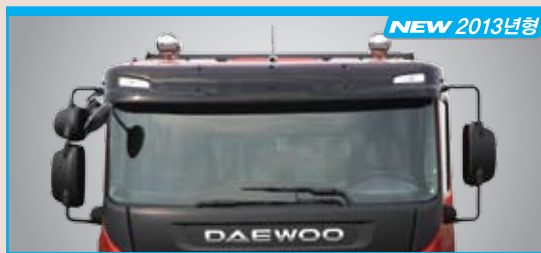
전동 조절식 아웃사이드 미러 : 전동식으로 편리하게 미러 각도 조절이 가능하며 열선이 내장되어있어 우천시 시야 확보를 도와줌
