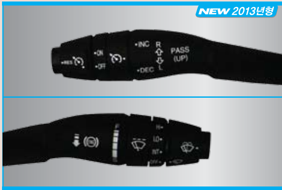
콤비네이션 레버 스위치 : 보조브레이크 스위치가 콤비네이션 레버에 내장되어 조작성 편리함(방향지시등에 원터치 트리플 기능 적용)
