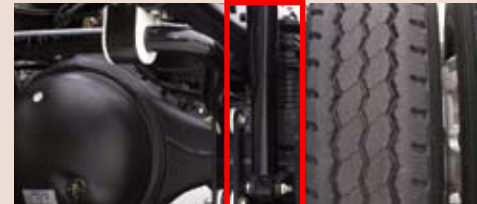
리어 속업쇼버: 차량의 충격을 흡수하는 속업쇼버를 적용하여 차량 안정성 향상(싱글 리덕션 차량 제외)
