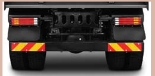
리어 리플렉터: 후면의 차량으로부터 안전성을 확보하기 위하여 시인성을 보강한 리어 리플렉터
