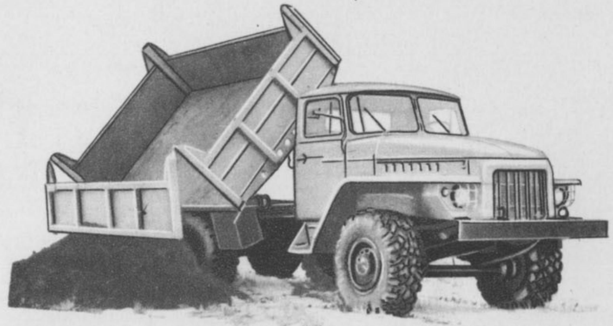
Самосвал снабжен гидравлическим подъемным механизмом для опрокидывания кузова на три стороны. При помощи этого механизма можно поднять кузов на угол до 50° и остановить в любом промежуточном положении при подъеме или опускании. Управление подъемом и опусканием кузова осуществляется из кабины водителя, причем кузов автоматически встремливается в конце подъема.
