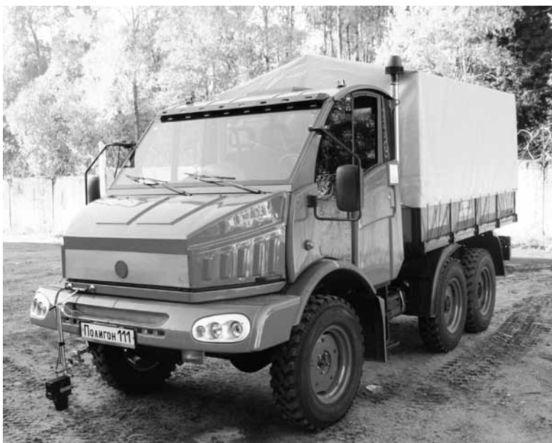
Рис. 1. Опытный образец трехосного грузового автомобиля малой размерности сельскохозяйственного назначения НАМИ-3333 во время испытаний на устойчивость на Автополигоне ФГУП «НАМИ»
