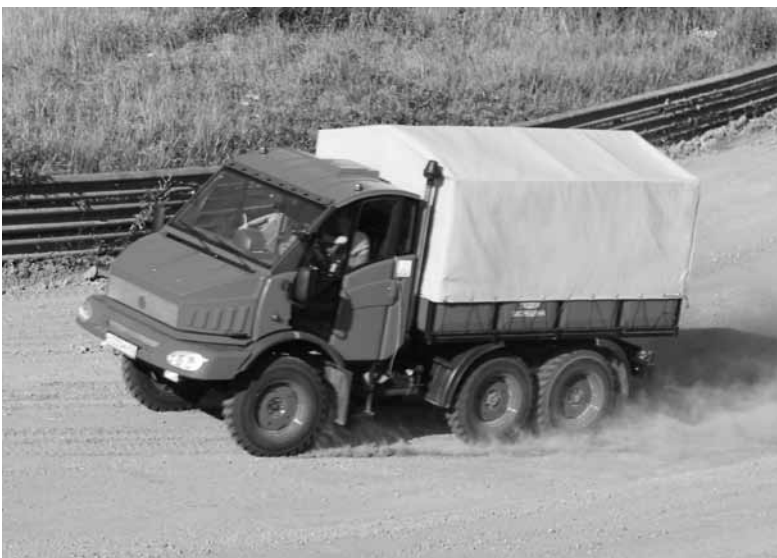
Рис. 2. Опытный образец трехосного грузового автомобиля малой размерности сельскохозяйственного назначения НАМИ-3333 во время испытаний на определение топливной экономичности на Автополигоне ФГУП «НАМИ»
