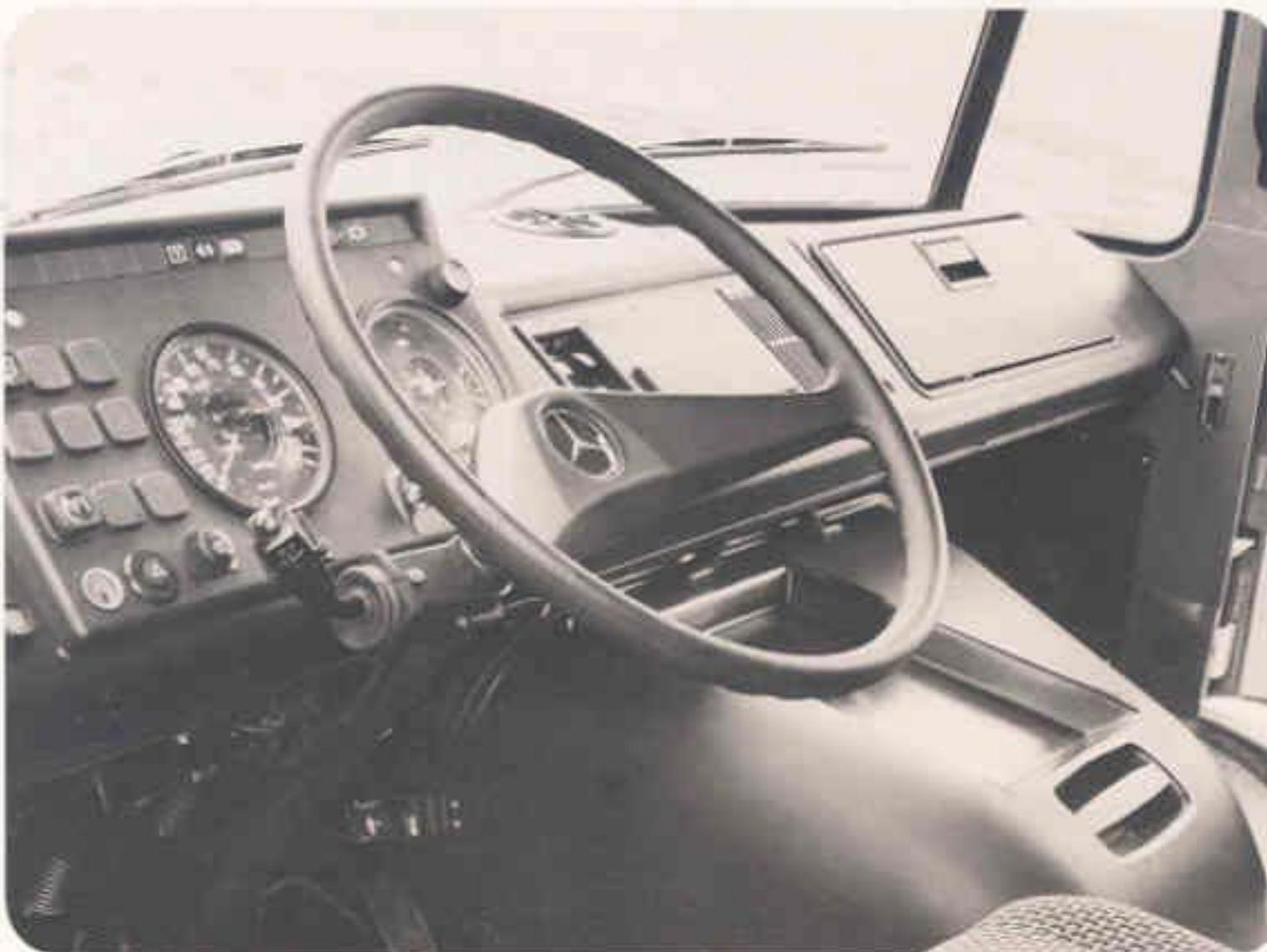
En helt ny ratt med kombispak. Ratten är inklädd och ger därför ett bra grepp. Ny instrumentbräda med lätt avläsbara instrument och signaler. Reglagen för varm- och kallluftintagen är försänkta. Handskfack med lock. Radions placering är förberedd. Ny kompakt motorhus med plats för körorder o/dyl. Rattlås på 1979 års modeller.
