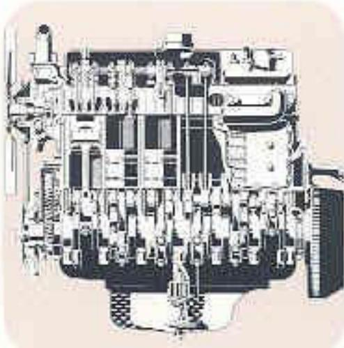
OM 352 – 6-cylindrig direktinsprutad dieselmotor på 96 kW (130 hk) DIN. Vridmoment 363 Nm (37 kpm) vid 2000 v/min.
