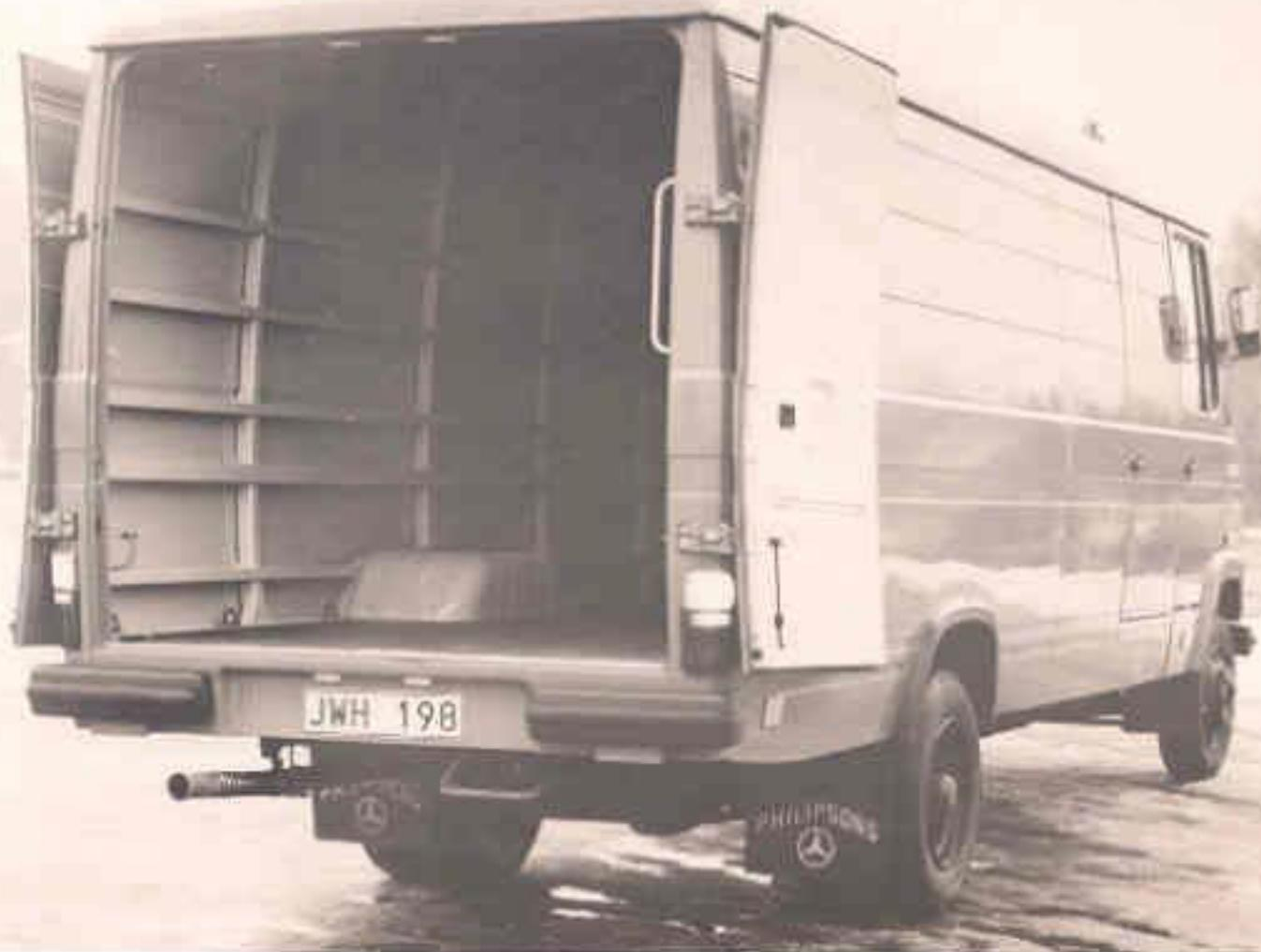
Skåpbilen har stora lastdörrar baktilf, som kan öppnas i 270° vinkel. Stoppljusen är synliga även när dörrarna är öppnade — en säkerhetsdetalj vid lastning och lossning, speciellt under den mörka årtiden.
