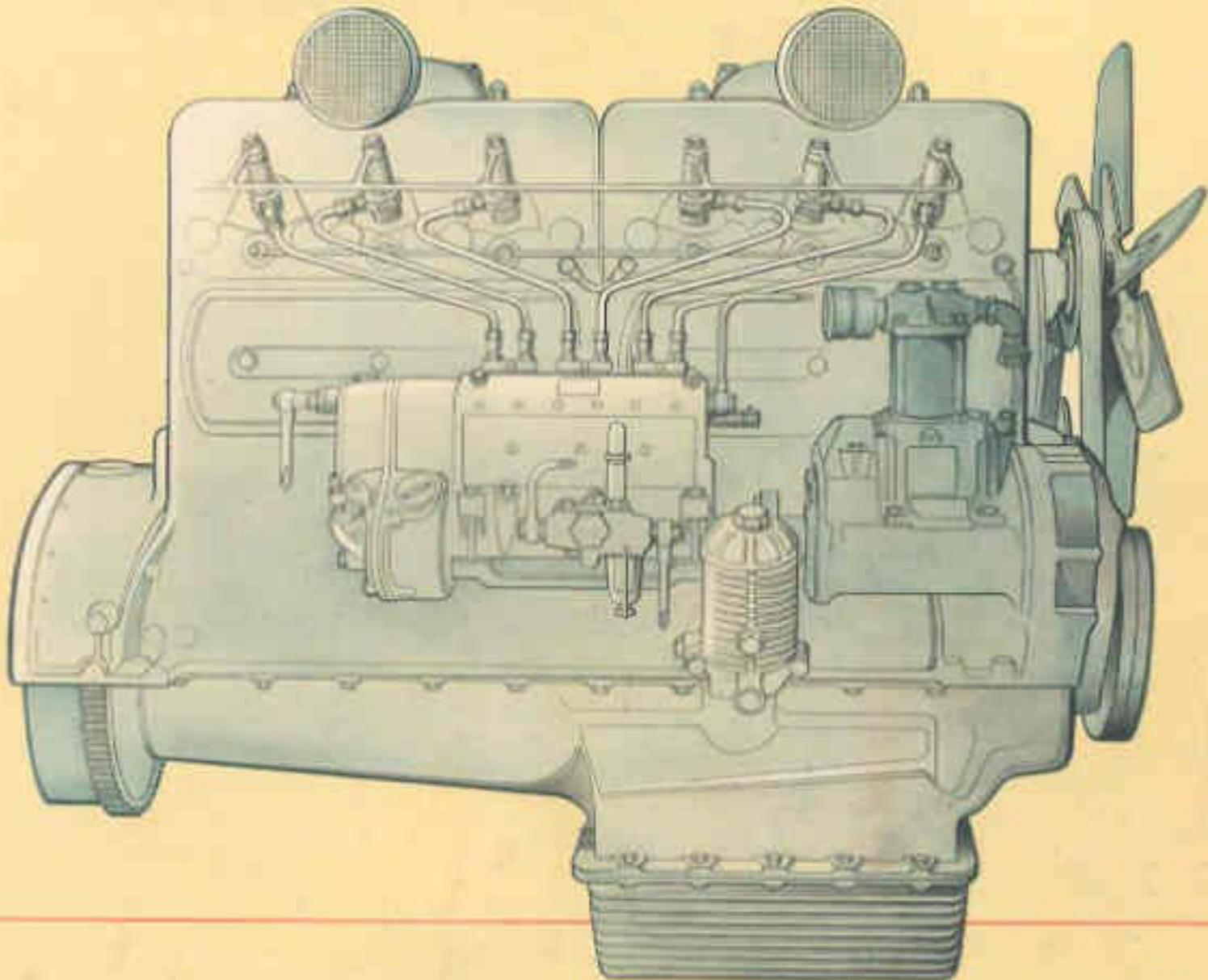
**D**er 120 PS Sechszylinder-Dieselmotor der Mercedes-Benz LKW-Laufkraftwagen 1.5000 ist durch seine Leistung und Widerstandsfähigkeit auch gegen härteste Anforderungen überall in der Fachwelt bekannt. In zusammenhang mit Mercedes-Benz-Nutzkraftfahrzeugen hat dieser
