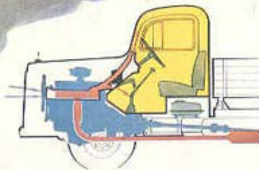
Durch die Kombination eines äußeren und inneren Schwenkfesters auf beiden Seiten des Fahrerhauses wird eine sehr willkürliche Durchlüftung des Innerraumes unter Vermeidung jeglicher Zugluft erreicht. Im Winter sorgt eine serienmäßig eingebauter Heizer für Entfernung der Windschutzscheibe und angenehmen Aufenthalt im Fahrerhaus. Die Hitze des Kühler abgesaugte Frischluft wird in einem Doppelleiter über dem Auspuffkanal erwärmt und kann dann wohlweise zum Heizen oder Entfrieren verwendet werden.
