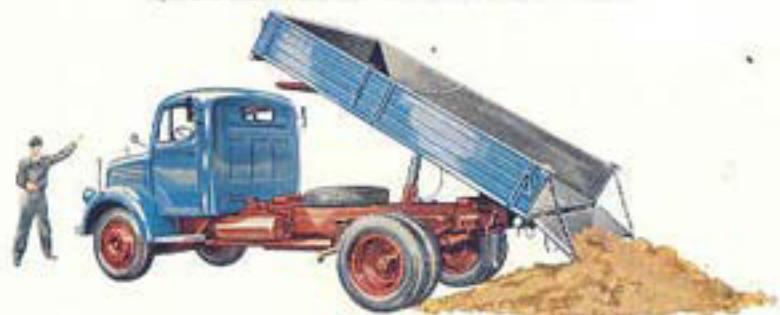
motorhydraulische Mercedes-Benz-Dreiseitenkipper steht
