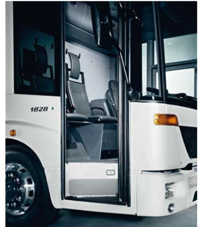
Das Econic-Standardfahrerhaus mit voller Stehhöhe und durchgehendem Fahrerhausboden bietet einen bequemen Ein- und Ausstieg und Platz genug für Fahrer und bis zu drei Beifahrer.
