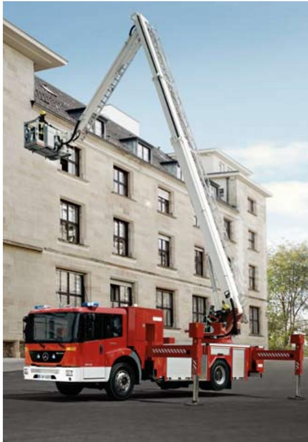
Hoch hinaus: Ist der Eonic in Stellung gebracht, sorgt die Abstützung in Verbindung mit der aufbaufreundlichen Gewichtsverteilung für optimale Stand-sicherheit sowie größtmögliche Ausladung und Flexibilität.
