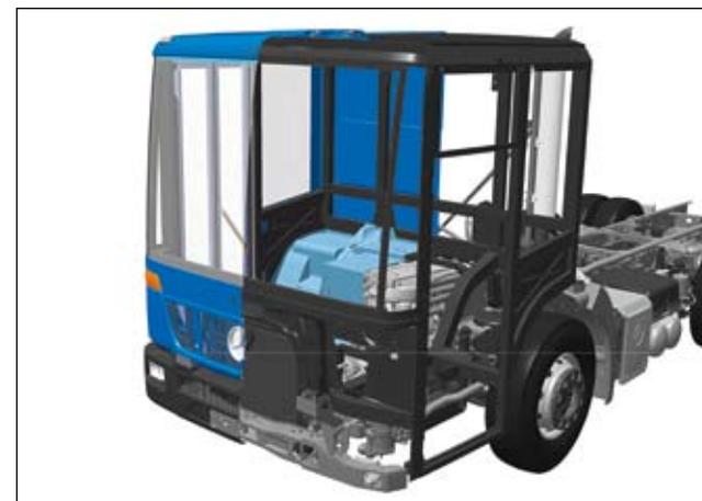
Leicht und sicher: Die Fahrerhäuser des Eonic sind in Aluminium-Leichtbauweise gefertigt, crashgetestet und erfüllen die europäische Crashtest-Norm ECE R29/2.
