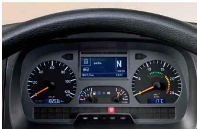
Das Kombiinstrument zeigt die wichtigsten Fahrzeugdaten auf einen Blick an. Zudem können Textmeldungen und auf Wunsch Trailer-Daten angezeigt werden. Und bei bestimmten Fahrzeugkonfigurationen hilft der variable grüne Drehzahlbereich, Diesel zu sparen.
