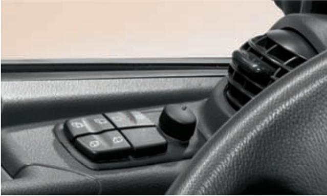
Die beleuchteten Schalter für Zentralverriegelung, Fensterheber, Spiegeleinstellung und Spiegelheizung sind äußerst bedienfreundlich angeordnet. Die Kugel-Luftdüse verhindert im Winter das Beschlagen oder Zufrieren der Seitenscheiben und im Sommer kann sich der Fahrer kühle Luft zuführen lassen.
