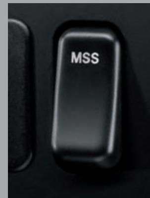
Die neue, auf Wunsch erhältliche Motor-Start-Stopp-Anlage macht den Atego noch umweltfreundlicher und sparsamer. Sie schaltet den Motor zum Beispiel an roten Ampeln oder im Stop-and-go-Verkehr automatisch ab und startet ihn automatisch wieder, sobald es weitergeht. Das spart jede Menge Kraftstoff und reduziert CO<sub>2</sub>-Emissionen.
