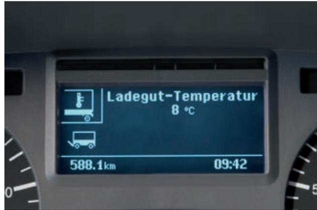
Mit der auf Wunsch erhältlichen Trailer-Integration kann sich der Fahrer Informationen über seine Ladung anzeigen lassen – zum Beispiel Temperatur, Druck und Menge bei Gas- oder Flüssigtransporten. Mit FleetBoard® können die Daten auf Wunsch auch in der Zentrale abgerufen werden.
