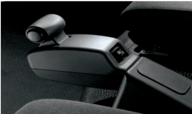
Mit der auf Wunsch erhältlichen Telligent®-Schaltautomatik wird der Fahrer zum Beispiel im Stadtverkehr entlastet und kann sich voll auf das Verkehrsgeschehen konzentrieren. Für eine vorausschauende Fahrweise, wie das zeitige Zurückschalten vor einer Steigung, kann er aber jederzeit manuell schalten.
