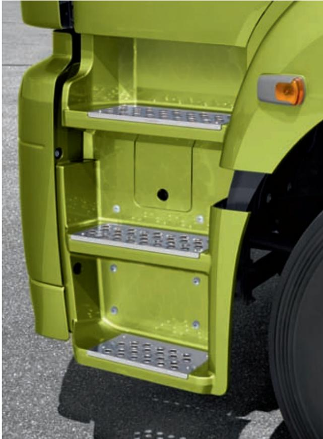
Die für Atego und Axor erhältlichen Trittstufen aus poliertem Edelstahl sind leicht zu montieren und sorgen im wahrsten Sinne des Wortes für einen glänzenden Auftritt. Weitere Edelstahl-Komponenten wie Dachlampenträger, Drucklufthörner oder Radzierblenden finden Sie in unserem ausführlichen Zubehörkatalog.
