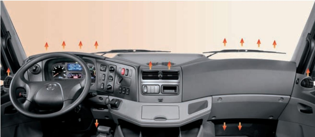
Der Axor verfügt serienmäßig über eine leistungsfähige, luftgeregelt Heizungs- und Lüftungsanlage. Auf Wunsch sind eine manuell regelbare Klimaanlage für Konditionserhaltung und Fahrsicherheit an heißen Tagen sowie eine leise arbeitende Warmluft-Zusatzheizung erhältlich.
