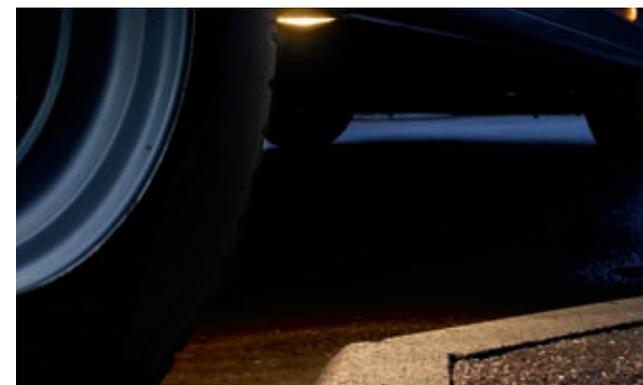
Der auf Wunsch für den Atego erhältliche Arbeitsscheinwerfer als Rangierhilfe leuchtet bei Dunkelheit den Bereich um die Hinterräder aus. Das unterstützt den Fahrer beim Rangieren und verhindert unter Umständen unnötige Beschädigungen an Fahrzeug oder Umgebung.
