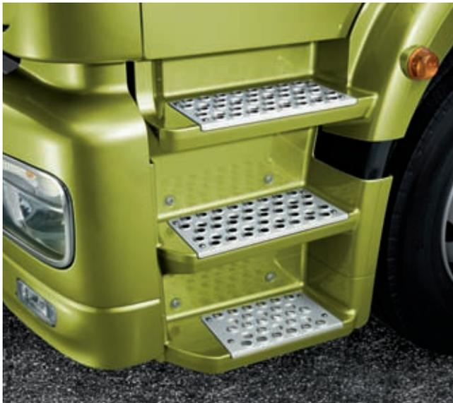
Breite, rutschhemmende und beleuchtete Trittstufen, besonders weit öffnende Türen und Haltegriffe an beiden Seiten sorgen dafür, dass man im Axor besonders komfortabel, kräfteschonend und sicher an seinen Arbeitsplatz kommt.
