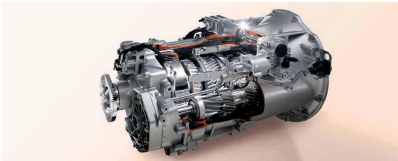
Serienmäßig kommt im Axor ein mechanisch-pneumatisch geschaltetes 9-Gang-Direktgang-Getriebe (acht Gänge, ein Kriechgang) zum Einsatz. Eine exakte Schaltwege und eine hydraulisch betätigte Einscheibenkupplung ermöglichen einen schnellen Kraftschluss und hohen Schaltcomfort. Die einsatzorientierte Gangabstufung sorgt auf der Landstraße, im Stadtverkehr und beim Rangieren für eine optimale Zugkraftumsetzung.
