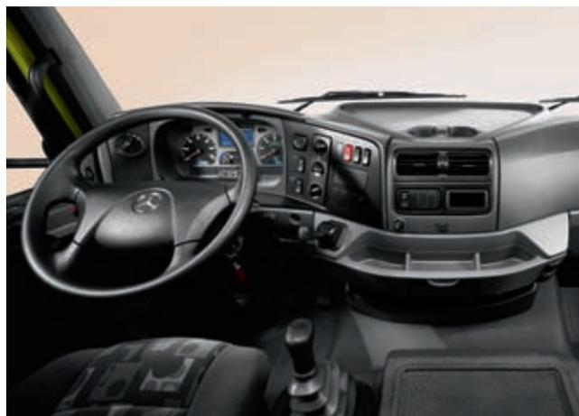
Das auf Wunsch erhältliche Fernverkehrs-Cockpit bietet durch die vorgezogene Brüstung weitere großzügige Ablagemöglichkeiten. Der Hebel für die Feststellbremse ist bei dieser Cockpit-Variante in die Brüstung integriert. Das erhöht den Bedienkomfort.
