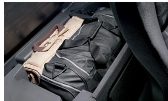
Unter dem Standard-Bett im L-Fahrerhaus befinden sich drei große Staufächer, von denen das mittlere mit einem Kühlschrank ausgestattet werden kann. Für alle, die nicht oder nur im Notfall übernachten müssen, ist alternativ zum unteren Bett eine klappbare Liege erhältlich.
