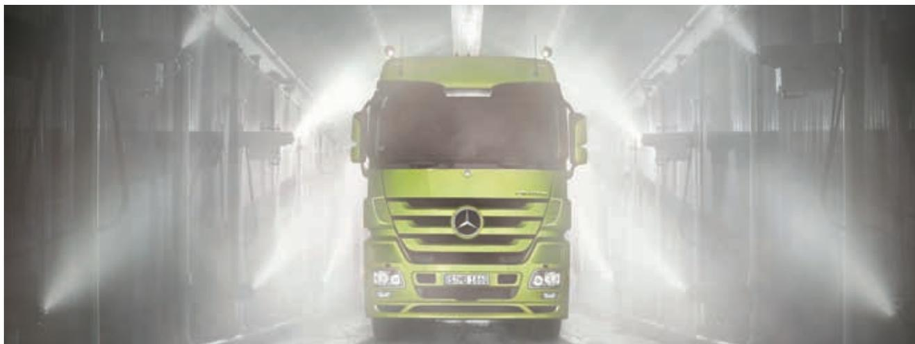
Witterungsbelastung im Zeitraffer: Bei dem dynamischen Korrosionstest wird der Lastwagen in der Salznebelkammer und in der Klimakammer monatelang extremen klimatischen Bedingungen ausgesetzt. Um die Korrosionsschutz-Qualität des Gesamtfahrzeugs zu prüfen, absolviert er zusätzlich im Wechsel kilometerlange Fahrprogramme auf »Schlechtwegstrecken«, Autobahnen, Schotter- und Schmutzstrecken.
