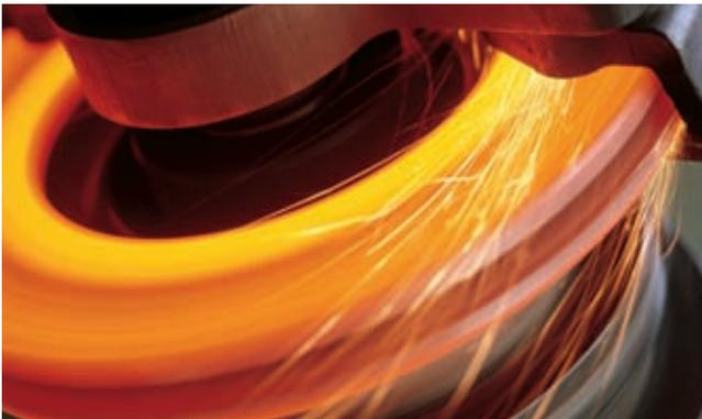
Damit die Bremscheiben von Atego und Axor im Ernstfall optimale Sicherheit bieten, müssen sie unter anderem die extremen Belastungen auf dem Schwungmassen-Reibungsprüfstand tadellos überstehen. Das Ergebnis: Die Bremscheiben zeigen kaum Fading – auch bei hoher Beanspruchung ist die Bremswirkung nahezu unverändert.
