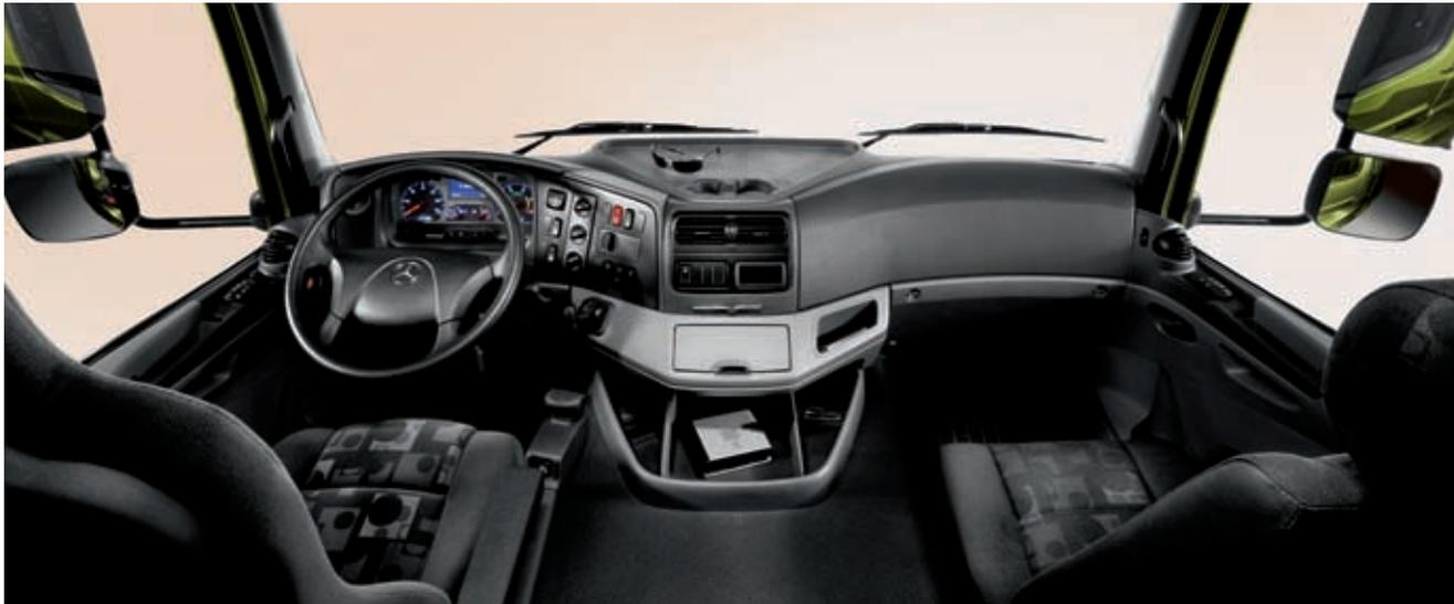
Für den schweren Verteilerverkehr gemacht – beim Axor ab 265 kW (360 PS) ist der Motortunnel um 120 mm abgesenkt. Das ermöglicht einen bequemen Durchstieg zur Beifahrerseite. Auf Wunsch sind unterschiedliche Ablagen oder zum Beispiel auch ein Mittelsitz erhältlich.
