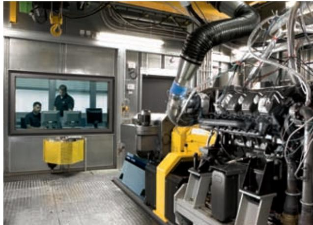
Im Verteilerverkehr ist Zuverlässigkeit alles. Deshalb müssen die Motoren von Atego und Axor Prüfstandsdauerläufe durchstehen, die mit einer Laufleistung von gut 3,6 Millionen gefahrenen Kilometern vergleichbar sind. Denn nur ein Motor, der so lange und zuverlässig arbeitet, ist optimal auf die Anforderungen im Verteilerverkehr vorbereitet.
