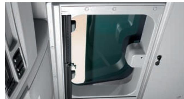
Das im L-Fahrerhaus mit Hochdach serienmäßige Kunststoff-Hebedach ist auf Wunsch auch aus Glas erhältlich. Es lässt sich elektrisch öffnen und schließen und kann auch bequem vom Bett aus bedient werden.
