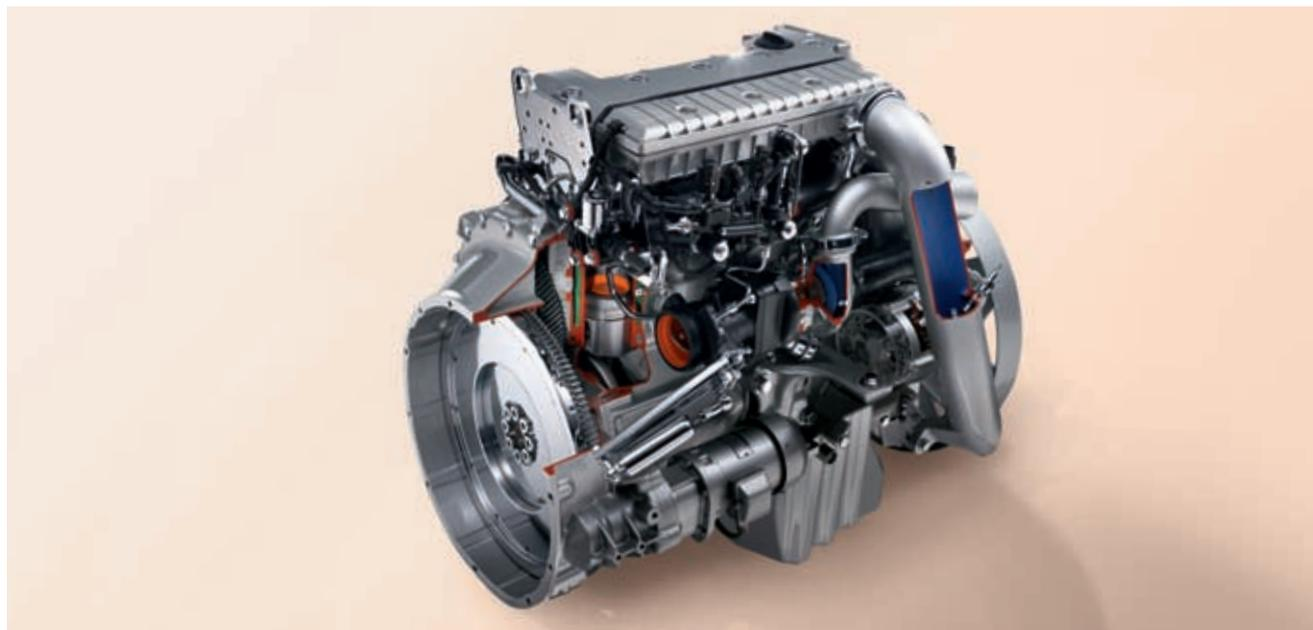
Der 4-Zylinder-Reihenmotor mit 4,8 l Hubraum und 160 kW (218 PS) verfügt über ein Leistungsangebot, wie man es eigentlich erst von 6-Zylindern erwartet. Ein weiterer Vorteil dieses Kraftpakets: Er bringt gut 100 kg weniger als ein 6-Zylinder-Motor mit vergleichbarer Leistung auf die Straße.
