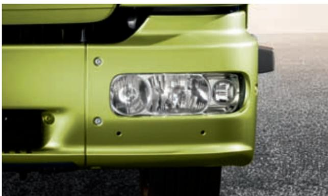
Die Klarglas-Scheinwerfer des Atego sehen nicht nur gut aus, sondern sorgen im Verteilerverkehr für optimale Sicht und Sicherheit. Die Blinker in Monochrome-Technik sind im Kühlergitter integriert.
