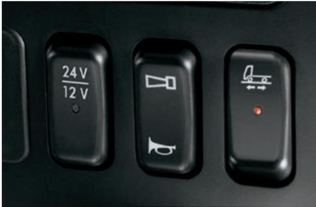
Mercedes PowerShift sorgt mit gezielt zuschaltbaren Programmen, wie dem Rangier-Modus und der Kickdown-Funktion, für ein besseres Fahrzeughandling sowie für mehr Sicherheit und Wirtschaftlichkeit im schweren Verteilerverkehr. Mercedes PowerShift ist auf Wunsch für Axor ab 265 kW (360 PS) erhältlich.
