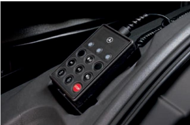
Mit der bei luftgedephten Atego serienmäßigen Telligent®-Niveauregelung lässt sich der Rahmen des Atego um bis zu 120 mm anheben oder um bis zu 80 mm absenken. Zudem sorgt sie beim Beladen dafür, dass die Ladefläche trotz zunehmender Last auf gleicher Höhe bleibt.
