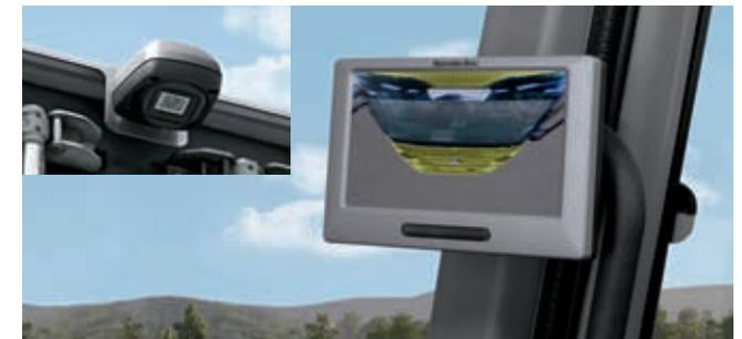
Das Rückfahrkamerasytem wird beim Einlegen des Rückwärtsganges automatisch aktiviert. Es macht den Bereich direkt hinter dem Fahrzeug einsehbar und erhöht so zum Beispiel beim Rangieren Sicherheit und Unfallschutz.
