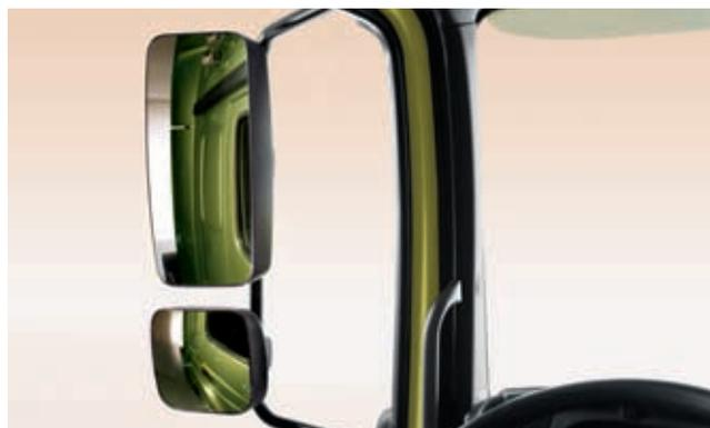
Großflächig und manuell beheizbar bieten die Rückspiegel immer beste Rundumsicht im Verteilerverkehr. Der Weitwinkel-Außenspiegel ist zur besseren Übersicht unten angebracht und verkleinert den Toten Winkel zusätzlich.
