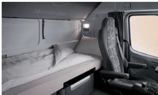
Im L-Fahrerhaus bietet das serienmäßige Standard-Bett mit seiner einteiligen, bequemen Federkernmatratze optimale Voraussetzungen für gesunden, erholsamen Schlaf. Mit dem Bedientableau in der Seitenwand können zum Beispiel Beleuchtung, Wecker und Zusatzheizung bedient werden.
