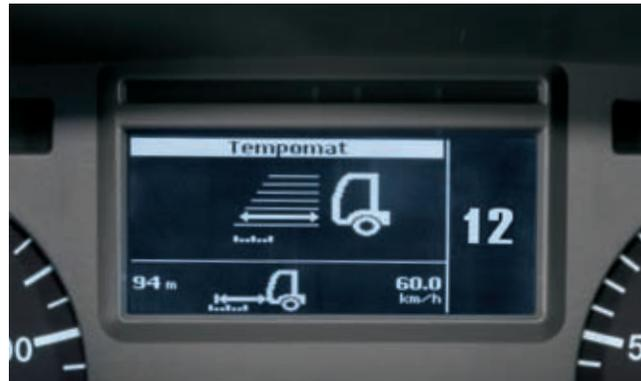
Die auf Wunsch lieferbare Telligent®-Abstandsregelung für den Axor ermöglicht entspannteres und sicheres Fahren. Denn Geschwindigkeit und Abstand des Axor werden sich ändernden Verkehrssituationen mit Hilfe des serienmäßigen, kombinierten Antriebs- und Brems-Tempomaten automatisch angepasst.
