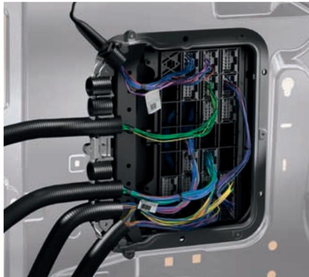
Die Aufbauerhersteller-Schnittstelle ermöglicht Aufbauerherstellern einen schnellen, unkomplizierten und damit kostengünstigen Zugriff auf elektrische Systeme und erleichtert die »Kommunikation« zwischen Fahrzeug und Aufbau im Fahrbetrieb.
