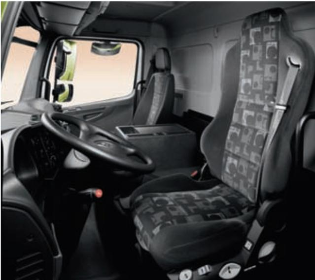
Der Komfort-Schwingsitz sorgt mit ergonomischer Form und vielen Einstellmöglichkeiten, wie zum Beispiel Lendenwirbelunterstützung und Seitenkonturanpassung, für optimalen Fahrkomfort. Optional kann er durch den Klima-Schwingsitz ersetzt werden, der Sitzwärme und -feuchtigkeit abführt. Beide Sitze sind auf Wunsch für Fahrer- und Beifahrerseite erhältlich.
