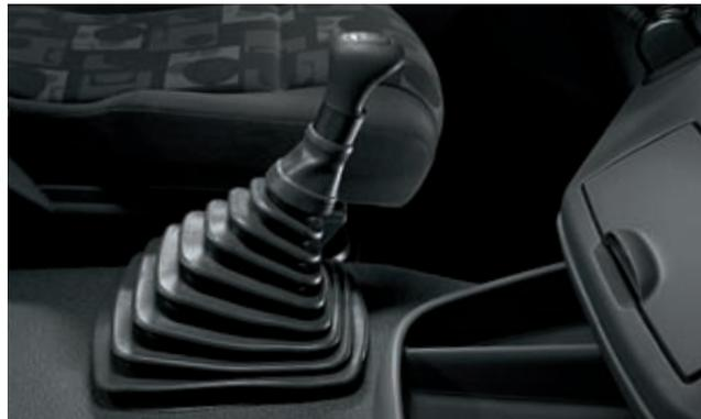
Egal, ob mit 6 oder mit 9 Gängen, die Schaltung des Atego sorgt für exakte Schaltwege mit hohem Schaltkomfort – auch deshalb, weil die Einscheiben-Trockenkupplung dank hydraulischer Unterstützung besonders leicht zu bedienen ist.
