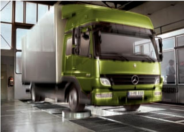
Die Auswirkungen extremer Belastungen, die im Verteilerverkehr häufig vorkommen, werden am sogenannten Hydropuls-Prüfstand untersucht. Dabei simulieren Hydraulikzylinder zum Beispiel die Kräfte, die bei der Fahrt über Schlaglöcher, Schotterwege und Bodenwellen auf den Rahmen wirken. Aber auch unterschiedliche Fahrmanöver auf befestigten Straßen, Kopfsteinpflaster und über Bordsteinkanten gehören zum Testprogramm.
