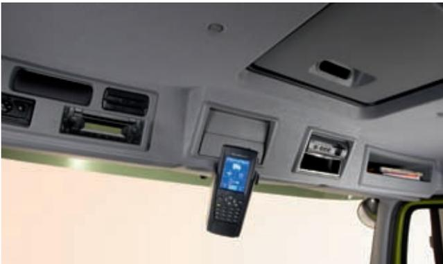
Oberhalb der Windschutzscheibe sind neben Tachograph und Radio auf Wunsch auch ein ab Werk lieferbares CB-Funkgerät, ein Navigationssystem sowie FleetBoard®, das Fahrzeug-, Flotten- und Transportmanagementsystem von Mercedes-Benz, integriert.
