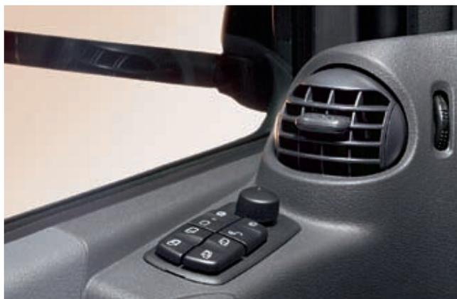
Das Türbedienfeld fasst wichtige Schalter zusammen – zum Beispiel für elektrische Fensterheber, Spiegeleinstellung und Spiegelheizung. Die Kugel-Luftdüse erhöht Sicherheit und Komfort, indem sie im Winter zum Beispiel das Beschlagen der Seitenscheiben verhindert.
