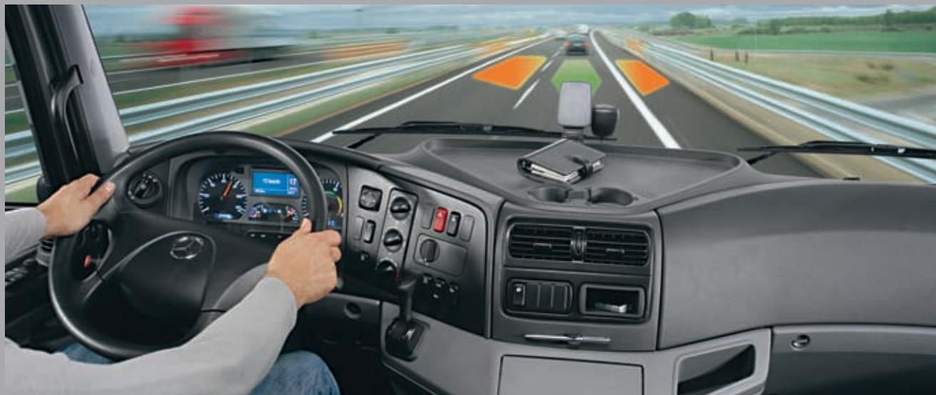
Der für den Axor optional erhältliche Telligent®-Spurassistent warnt den Fahrer vor unbeabsichtigtem Spurwechsel. Dazu prüft er permanent den Abstand zwischen Fahrzeug und Fahrbahnbegrenzung. Die Warnung erfolgt durch ein akustisches Signal, das über die Radiolautsprecher ertönt.
