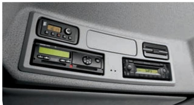
Die Kommunikationszentrale – in den genormten DIN-Schächten sind der digitale Tachograph und das Radio untergebracht. Zudem können hier zum Beispiel auch ein ab Werk lieferbares CB-Funkgerät und FleetBoard®, das Fahrzeug-, Flotten- und Transportmanagement von Mercedes-Benz, eingebaut werden.
