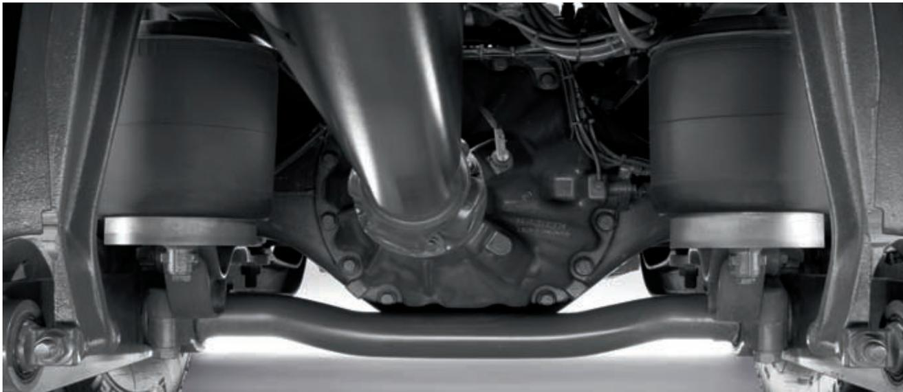
Die 2-Balg-Luftfederung kommt bei 4 x 2- und 6 x 2-Sattelzugmaschinen mit luftgefederter Antriebsachse serienmäßig zum Einsatz. Dabei sorgt die Anordnung der Federbälge direkt hinter der Achse für sehr gute Fahreigenschaften und eine ausgezeichnete Fahrdynamik.
