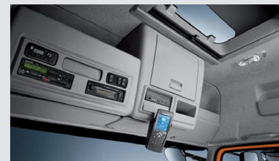
▲▲ Nei quattro scomparti a norma DIN sopra la parabrezza possono essere installati radio, sistema di navigazione, tachigrafo digitale o ricetrasmittente CB.
