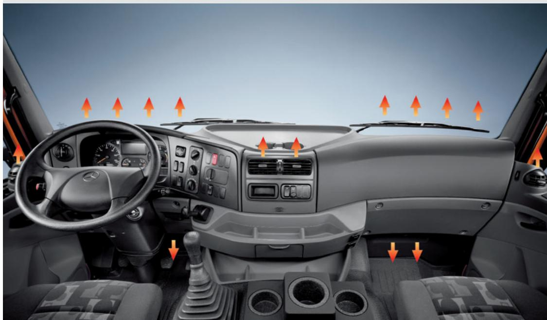
▲ Il riscaldamento ad aria può essere regolato individualmente ed è dotato di un sistema intelligente di canali e bocchette per la ripartizione dell'aria. Avendo tempi di reazione più immediati, risponde più rapidamente alle diverse impostazioni individuali della temperatura.
