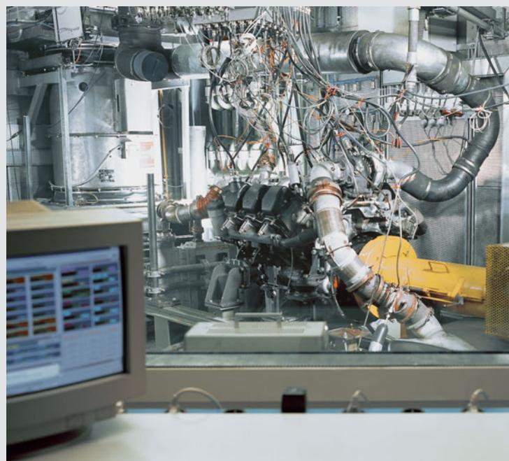
▲ Caldo-freddo, carico parziale, carico pieno, test di durata: complessivamente i nostri motori devono affrontare test di durata sul banco di prova che nella realtà corrisponderebbero ad una percorrenza di ben 3 600 000 km. E se un motore non supera questi test non verrà mai montato sull'Axor.
