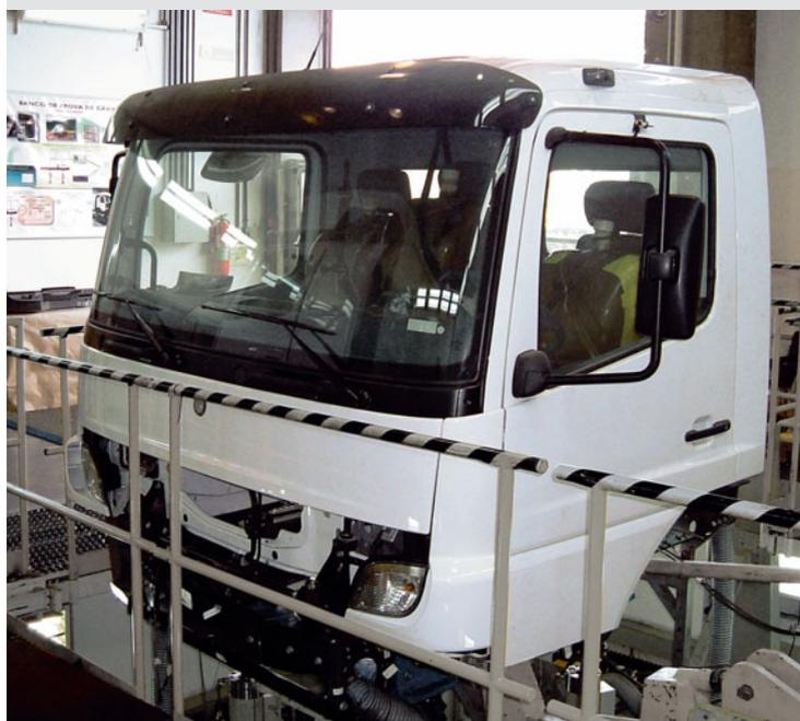
▲ Sui banchi di prova le nostre cabine vengono sottoposte a tutta una serie di test che simulano sollecitazioni notevolmente superiori a quelle che si presentano costantemente nell'uso quotidiano. Per verificare la resistenza di alcuni componenti, ad esempio, vengono simulate con l'idropulsatore condizioni di marcia sfavorevoli, come percorsi su strade accidentate.
