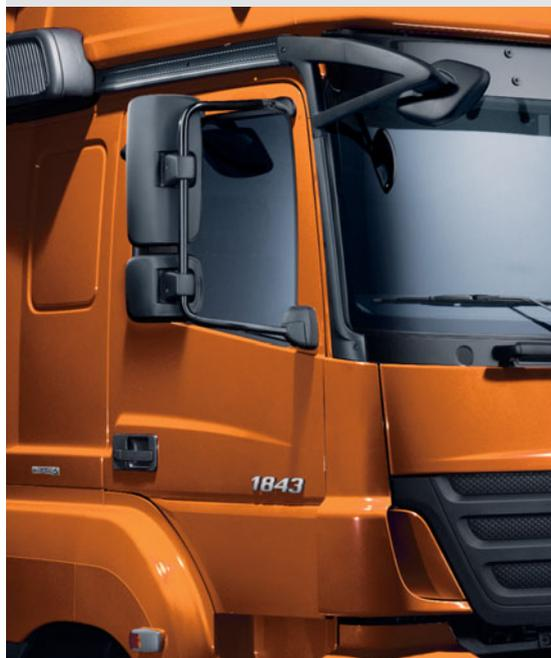
▲ I deflettori sul montante anteriore, i rivestimenti aerodinamici sui retrovisori e i rivestimenti angolari migliorano l'aerodinamica e riducono l'imbrattamento di porte e finestrini.
