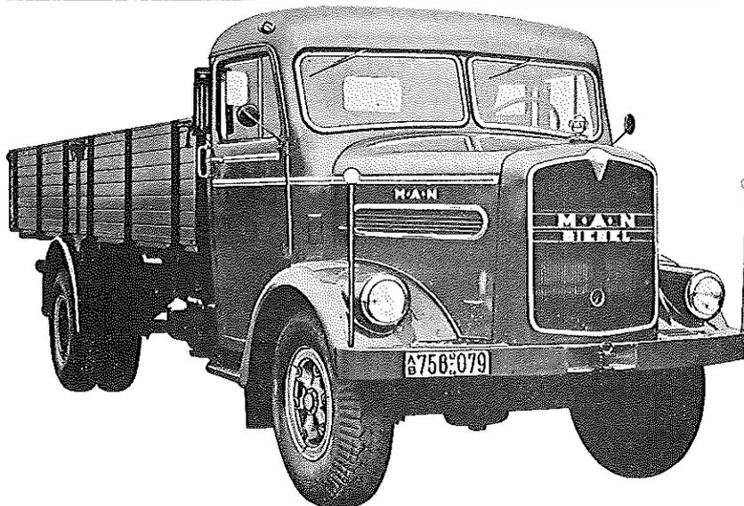
**Diesel-Motor · 6 Zylinder · 4-Takt · 135 PS bei 2100 U/min**
