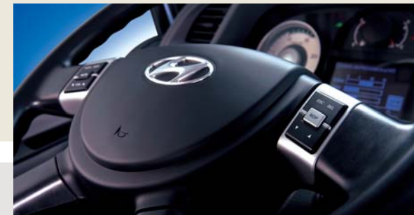
오디오 리모콘 내장형 스티어링 휠 오디오 리모콘 및 멀티점선 디스플레이 작동 스위치가 내장된 스티어링 휠은 뛰어난 운전 편의성을 제공합니다. (H0460, H0480오디오 및 H0495 AV 시스템 적용 차량)
