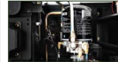
에어 드라이어 & 오일 세퍼레이터 : 브레이크 라인의 수분 및 이물질 제거하여 브레이크의 안전성을 높였습니다.
