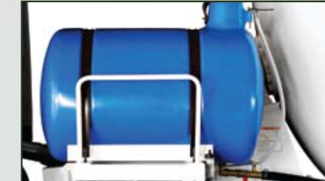
물탱크 : 콘크리트 혼합을 위해 충분한 물을 저장할 수 있는 PE 재질의 대용량 물탱크
