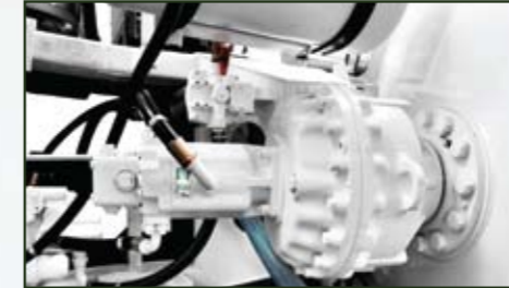
고성능 감속기 : 작동유 소모가 적고 감속 토크가 월등히 높은 감속기
