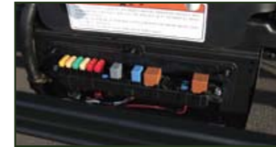
보조 안전 퓨즈박스 : 과부하가 많이 걸리는 퓨즈를 따로 모아서 배터리 측면에 부착 시켰습니다.
