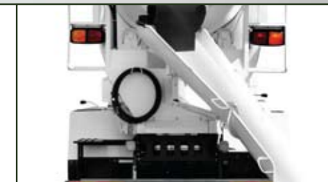
접이식 가이드 슈트 : 좌우 회전은 물론 접이식으로 설계되어 편리성이 더욱 향상됨
