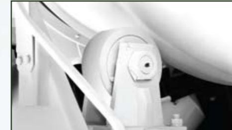
가이드 롤러 : 드럼의 하중과 주행시 발생하는 진동으로 인한 충격을 완화해주는 장치
