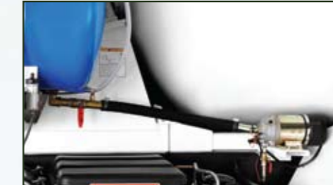
워터 펌프 세척 시스템 : 에어 차지 시간이 필요없어 작업 시간이 단축되고, 완벽한 세척이 가능
