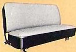
Il y a lieu de noter l'ampleur confortable du large siège Nu-Flex et la beauté du capitonnage qui "respire". Le siège et le dossier, montés sur un cadre unique, sont entièrement réglables et comportent des clapets à air amortissant les réactions de la route. Pour assurer le maximum de confort, la cabine peut être munie du siège Chevrolet Airmatic moyennant supplément.
