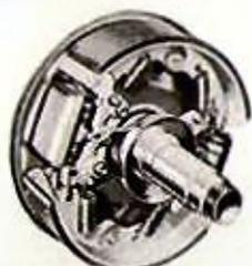
**LES FREINS A DOUBLE EFFET** produisent le maximum de serrage grâce à l'emploi de deux cylindres par roue. Les larges garnitures dissipent rapidement la chaleur et répartissent l'usure sur une grande surface. Livrés à l'arrière des modèles des séries 4000 à 10000 inclusivement, ainsi qu'à l'avant des séries 7000 à 10000.
