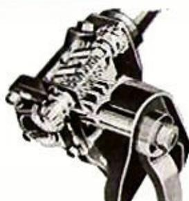
**DIRECTION A BILLES** — "Rien ne roule comme une bille." C'est là un aphorisme décrivant avec exactitude la douceur de braquage de cette direction. Des dizaines de billes en acier poli réduisent le frottement et contribuent à la fermeté et à la douceur du mécanisme. Livrée sur tous les modèles de camions ultra-modernes.
