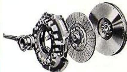
**GROS EMBRAYAGE** de 13" (33 cm.) de diamètre à larges garnitures spécialement étudiées pour les travaux pénibles avec le puissant moteur Loadmaster V8. Ventilation parfaite et gros ressorts à boudin assurant un fonctionnement impeccable et uniforme.
