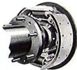
**LES FREINS A DOUBLE EFFET** mesurent 15" (38 cm.) de diamètre et comportent des garnitures de 4" (10 cm.) de largeur sur les roues arrière. Servo-freins Hydrovac ou freins hydraulique-air sur demande. La nouvelle commande à goujon et le système d'attache aux roues distribuent uniformément les efforts de freinage et permettent de démonter les roues extérieures sans les mettre sur cric.
