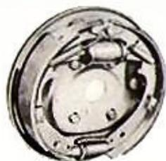
**FREINS A AUTO-SERRAGE** assurant des arrêts sûrs et rapides moyennant une légère pression sur la pédale. Sabots actionnés par la rotation des roues. Garnitures sans rivets à l'avant et à l'arrière de la Sedan de Livraison et de la série 3000. Celles des freins avant des séries 4000, 5000 et 6000 sont rivetées.
