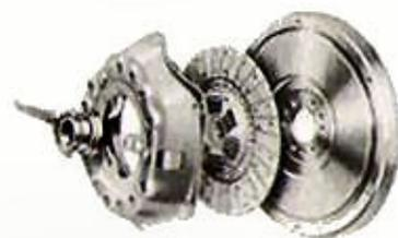
**EMBRAYAGE A RESSORTS A BOUDIN** — Etudié pour la transmission totale de la puissance des camions V8 ultra-modernes. De gros ressorts à boudin, agissant sur un grand diamètre, assurent une prise de bouledogue. Ce robuste et durable embrayage est un important élément de la transmission du mouvement aux roues arrière.
