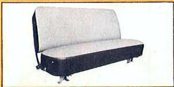
**LE SIÈGE NU-FLEX**, extrêmement confortable sur les routes les plus accidentées, est capitonné en drap poreux très durable. Le coussin en caoutchouc-mousse, facultatif dans la cabine de luxe, est de série dans la cabine Custom. Le siège AIR-MATIC, livré moyennant supplément sur toutes les cabines, peut être gonflé à l'aide d'une pompe à main, ce qui permet d'en régler la pression en vue du maximum de confort.
