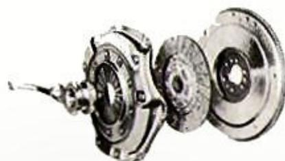
**EMBRAYAGE A RESSORT-DIAPHRAGME** — Le fameux embrayage Chevrolet à ressort-diaphragme, avec sa pédale aisément actionnée, facilite l'engagement du moteur avec l'arbre de transmission, après quoi cette douceur de fonctionnement se transforme en rigidité pour la transmission efficace du mouvement. Fait partie de tous véhicules Chevrolet à six cylindres.
