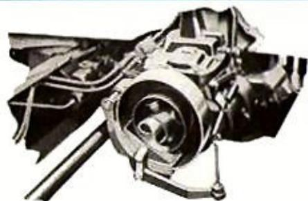
**LE FREIN SUR MECANISME** bloque solidement le véhicule sur toutes les pentes qu'il puisse grimper. Il est situé sur l'arbre de transmission, derrière la boîte, et la force de ce frein indépendant est multipliée par les pignons des arbres de pont arrière. Livré sur tous les modèles des séries 3800 à 10000. Fait partie des transmissions facultatives des modèles d'un quart de tonne.
