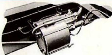
**LES SERVO-FREINS HYDROVAC** n'exigent qu'une faible pression sur la pédale pour donner l'impression d'un freinage parfait dans toutes les conditions. L'aspiration du moteur fournit environ les deux tiers de l'effort de freinage, ce qui évite la fatigue du conducteur. Livrés sur toutes les séries 5000 à 10000, facultatifs\* sur les séries 3000 et 4000.
