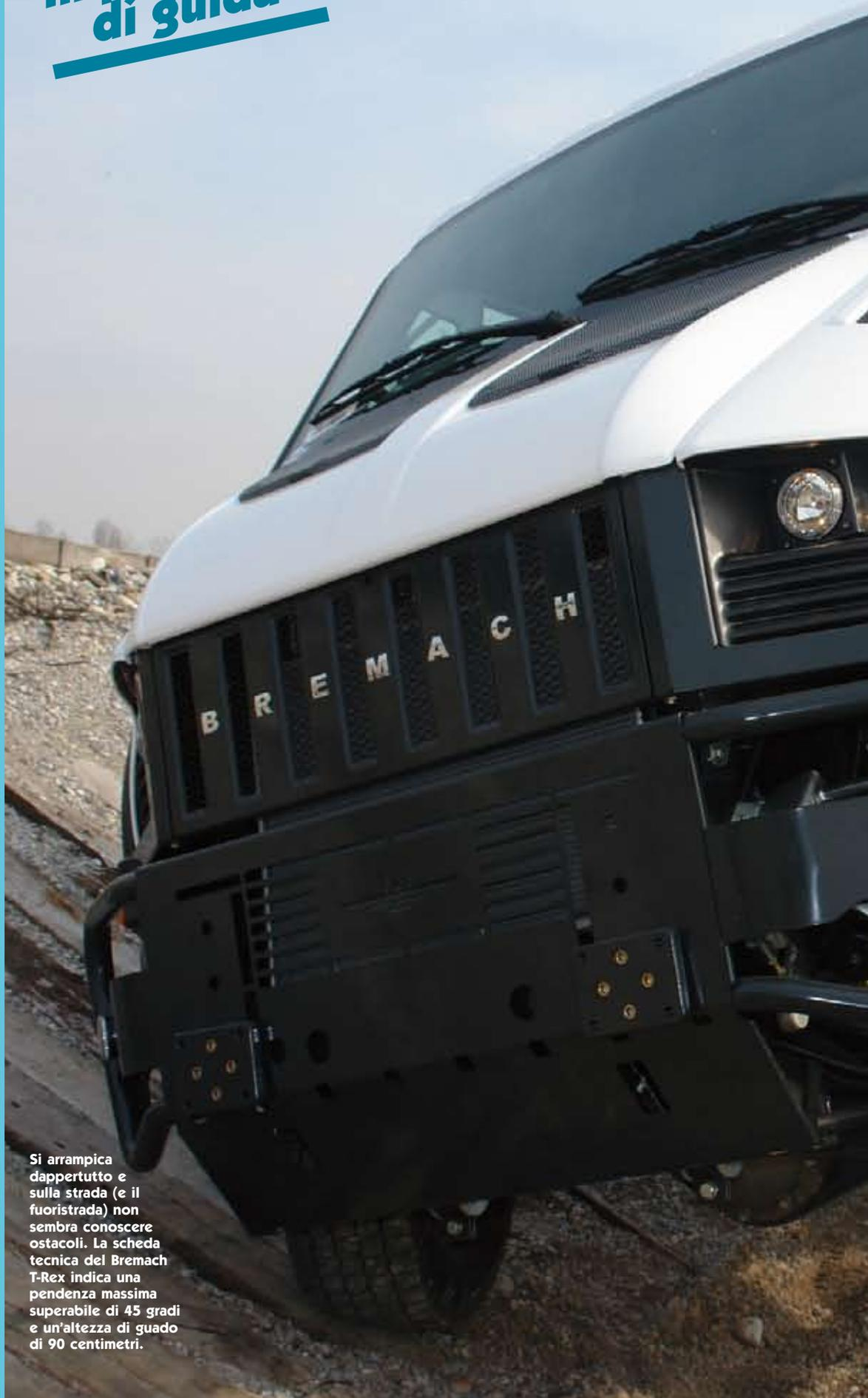
Si arrampica dappertutto e sulla strada (e il fuoristrada) non sembra conoscere ostacoli. La scheda tecnica del Bremach T-Rex indica una pendenza massima superabile di 45 gradi e un'altezza di guado di 90 centimetri.
