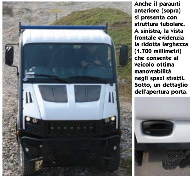
Anche il paraurti anteriore (sopra) si presenta con struttura tubolare. A sinistra, la vista frontale evidenzia la ridotta larghezza (1.700 millimetri) che consente al veicolo ottima manovrabilità negli spazi stretti. Sotto, un dettaglio dell'apertura porta.
