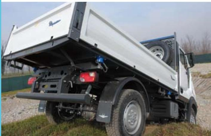
Lo sbalzo posteriore di 940 mm del T-Rex 35 quintali (sopra), sale a 990 millimetri sulla versione di fascia superiore da 6 ton. In funzione del passo la lunghezza carrozzabile massima varia tra 2.800 e 4.180 millimetri. A destra, un particolare dell'alloggiamento dei fari anteriori. Sotto, a sinistra, l'originale ancoraggio dei due gradini antiscivolo all'arco passaruota; a destra, l'ampia superficie vetrata dello specchio retrovisore.
