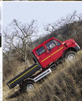
La compatta cabina da 1700mm, di tipo semi-avanzata, costruita integralmente in acciaio zincato, garantisce un lay-out veicolare capace di estendersi dai 2 o 3 posti della classica cabina singola, ai 5 o 6 posti della cabina doppia fino ai 9 (fino a 15) della configurazione VAN per trasporto di personale in zone disagiate o per avventurarsi in una vacanza spedizione nei deserti più sperduti del pianeta con i nostri allestimenti camper personalizzabili.
