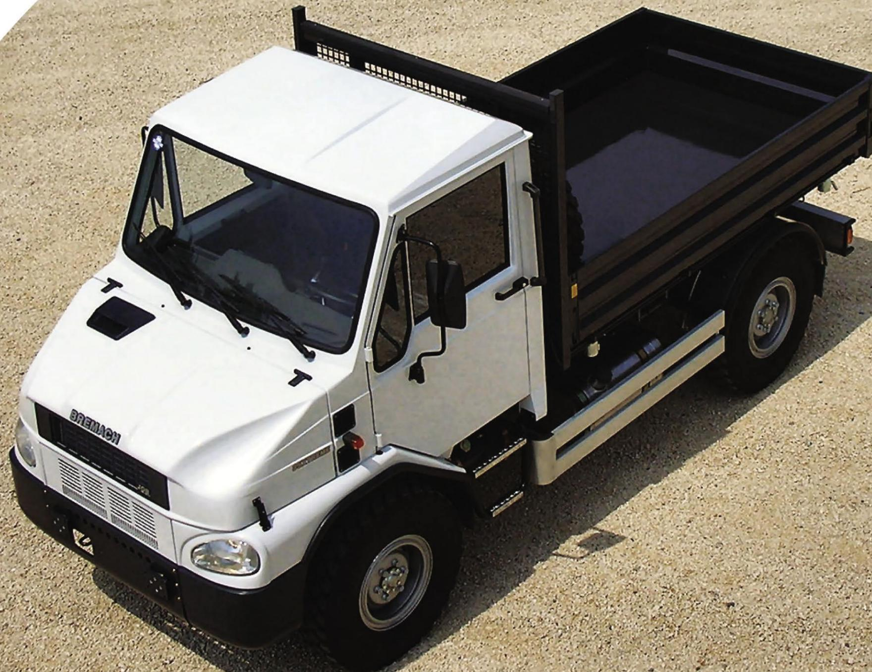
Grazie ai ridotti ingombri esterni, BREMACH è in grado di fornire mezzi speciali 4x4 dotati di una notevole carrozzabilità. Nel caso di allestimenti semplici ciò si traduce nella possibilità di allestire cassoni fino a 3,25m su cabinati semplici.
