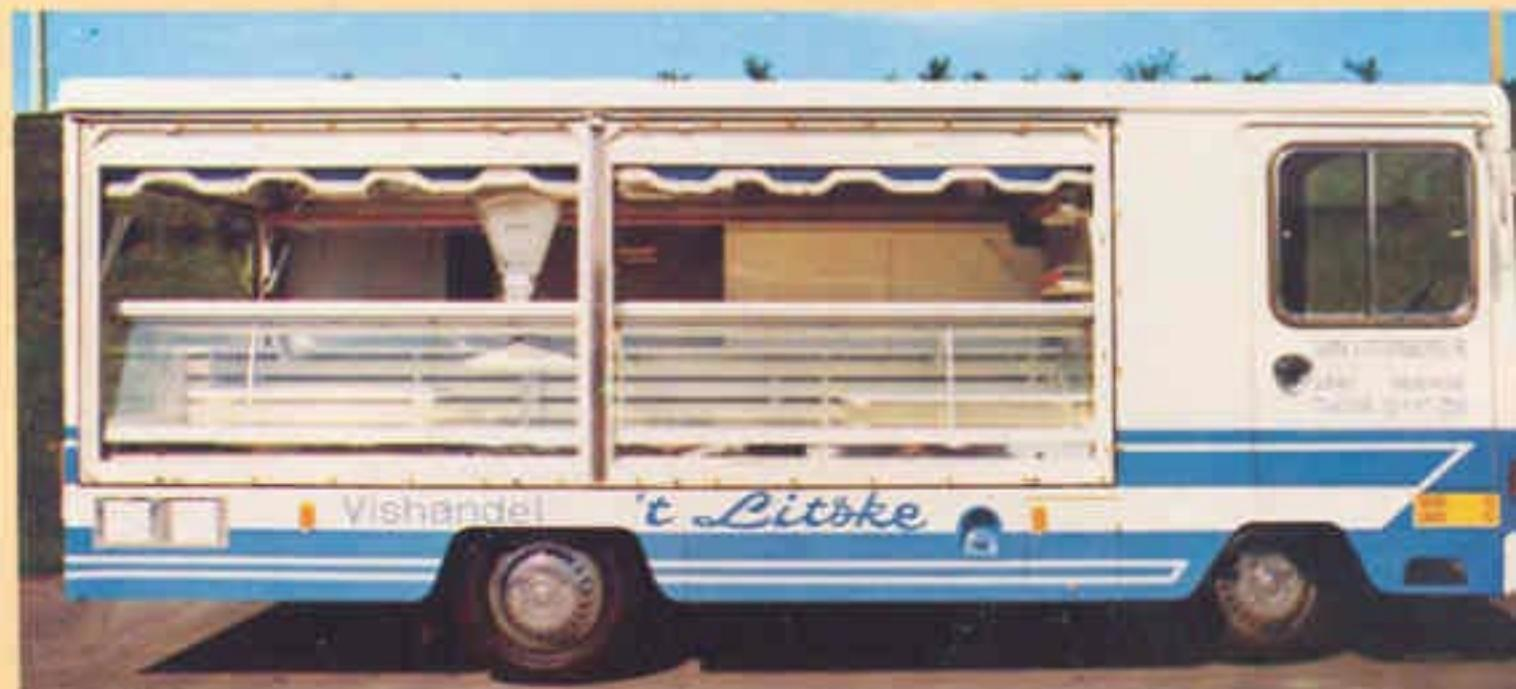
Het gebruik van een voorwielaandrijving bezorgt u een extra lage laadvloer.
