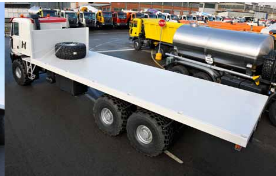
▼ HHD LONG WHEEL BASE WITH FLAT BED / HHD EMPATTEMENT LONG AVEC PLATEFORME
