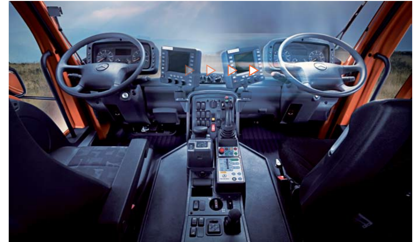
Mit einem Handgriff schieben Sie die VarioPilot®-Wechsellenkung von links nach rechts – ideal für den sicheren und bequemen 1-Mann-Betrieb
