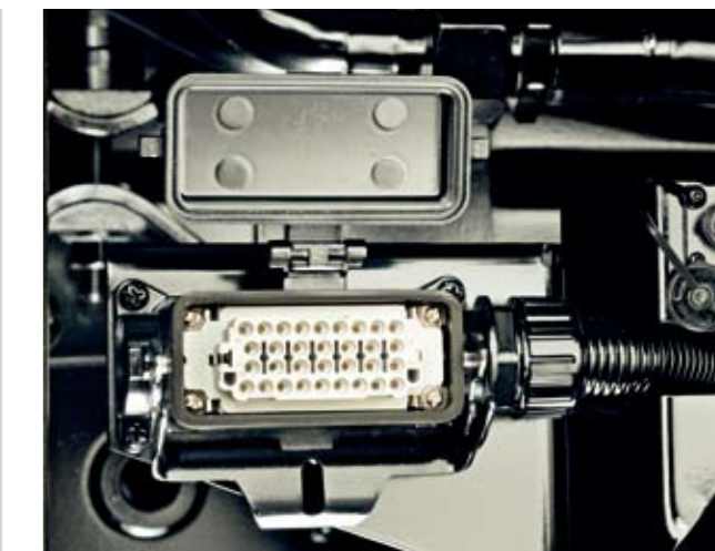
Die Gerätesteckdose zur elektrischen Versorgung von Geräten. Stromabnahme bis 40 A
