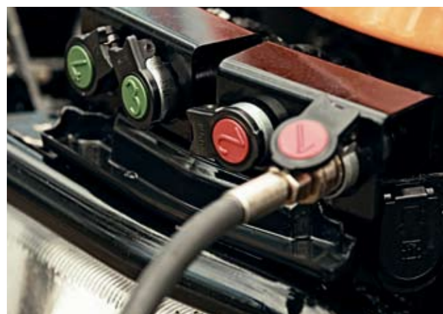
Die Anschlüsse für die Arbeitshydraulik sind farblich und numerisch gekennzeichnet – ideal für den schnellen und sicheren Geräteanschluss
