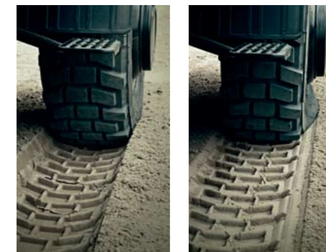
Mit tirecontrol regulieren Sie den Reifendruck während der Fahrt
