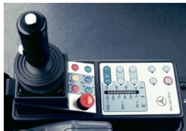
Mit dem kulissengeführten Joystick kontrollieren Sie alle Stellbewegungen – einfach und bequem
