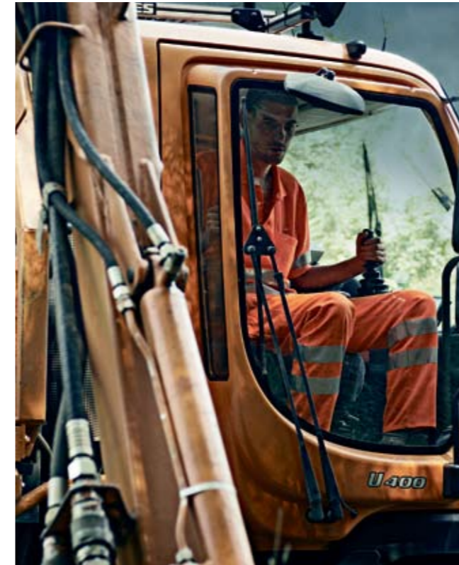
Mähtür und Drehsitz für beste Sicht und genügend Beinfreiheit
