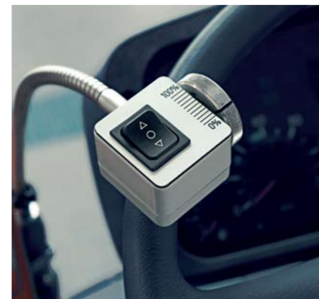
Per Handschalter können Sie den hydrostatischen Fahrtrieb individuell regeln
