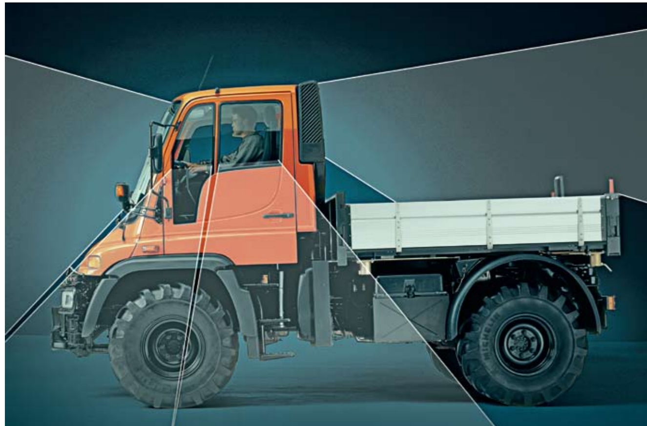
Beste Sicht nach allen Seiten durch die weit nach unten gezogene Frontscheibe, tiefe Seitenscheiben und das große Rückwandfenster
