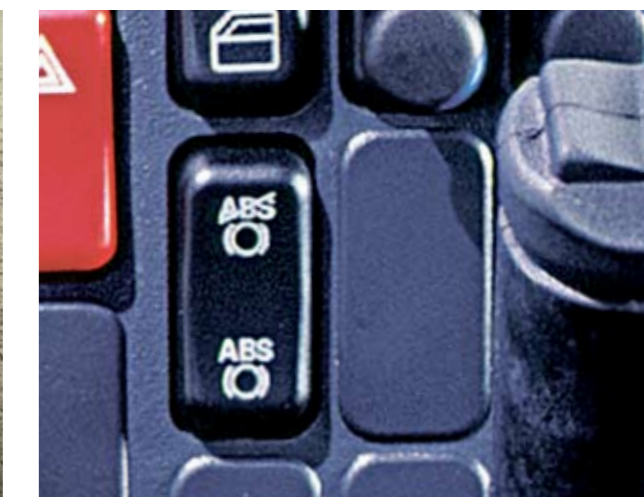
Noch mehr Sicherheit durch das abschaltbare Anti-Blockier-System (ABS)
