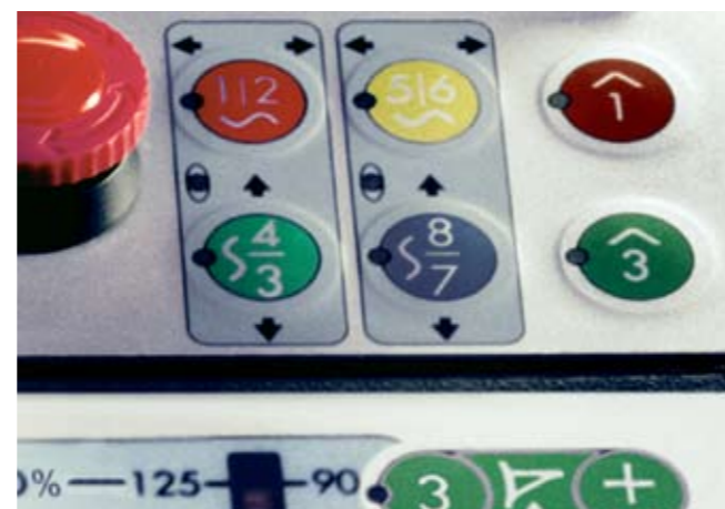
Das Tastenfeld zeigt die farblich und numerisch geordneten Ventile und Anschlüsse
