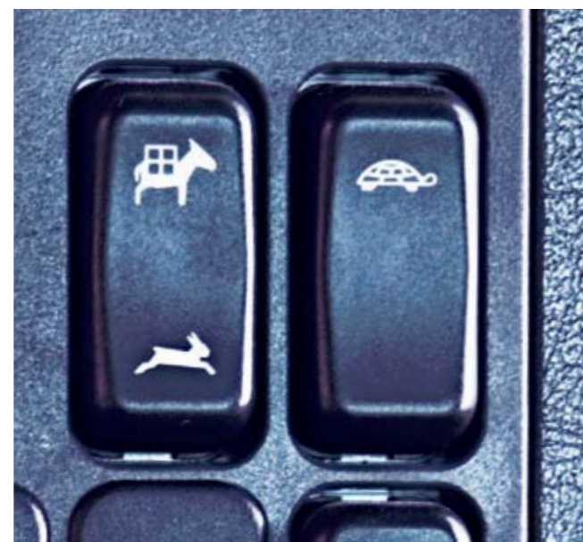
Kippschalter in der Mittelkonsole für die Grund-, Arbeits- oder Kriechganggruppe
