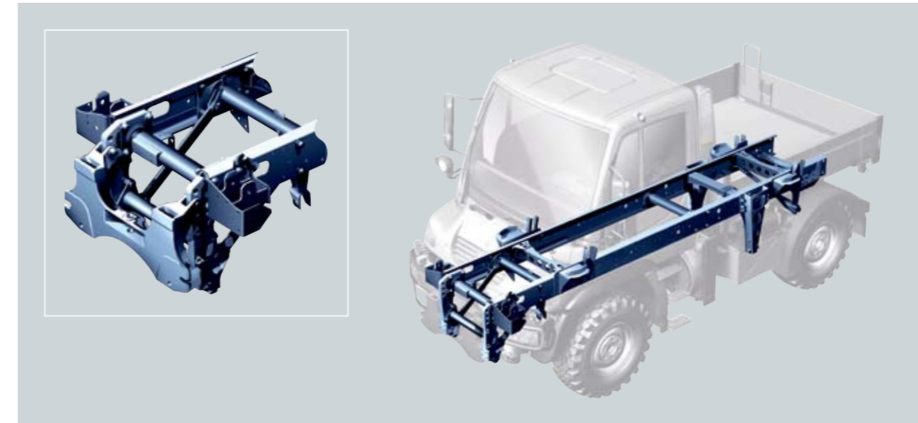
Ein durchgehender, stabiler Leiterraum mit integrierten Befestigungspunkten macht den direkten Geräteaufbau einfach und preiswert
