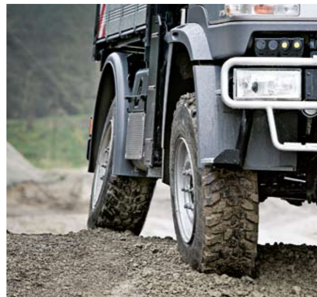
Stark im Gelände durch Achsverschränkung, permanenten Allradantrieb und zuschaltbare Differenzialsperren in beiden Achsen
