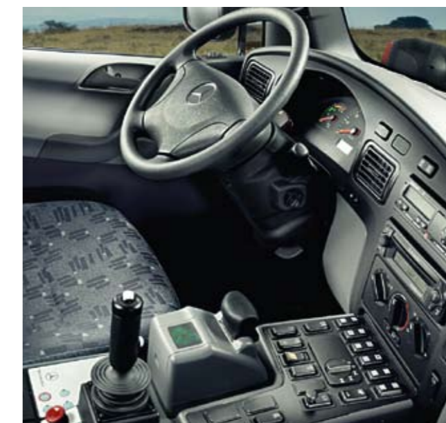
Bequem: das Frontlenker-Fahrerhaus mit großem Türöffnungswinkel und 3 Sitzen
