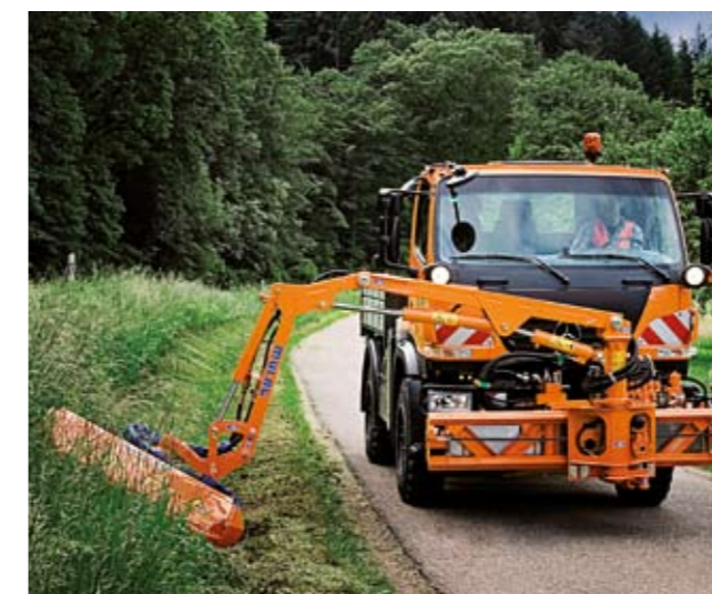
Starke Frontanbauplatte für Randstreifenmähergerät, Schneepflug u. a. Geräte
