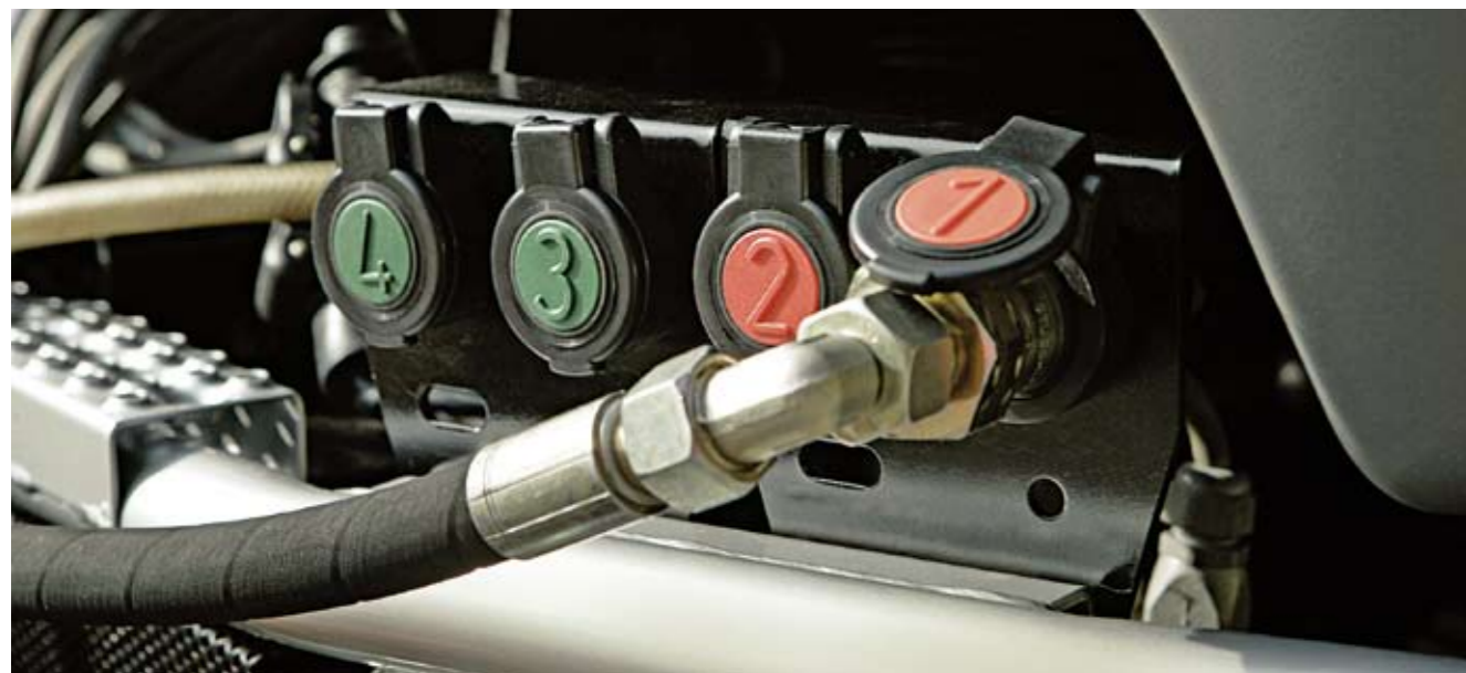
Farblich gekennzeichnete Hydraulikkupplungen – ideal für den schnellen und sicheren Geräteanschluss
