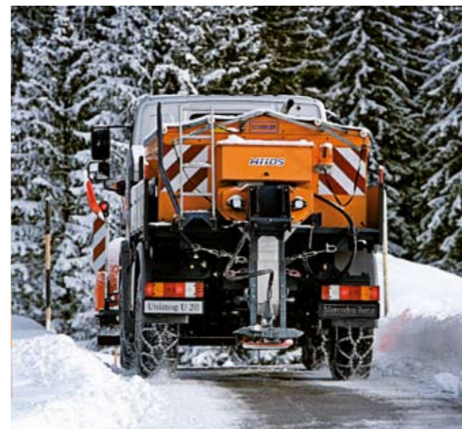
Permanenter Allradantrieb, Differenzialsperren in den Achsen und Single-Bereifung mit Schneeketten ...
