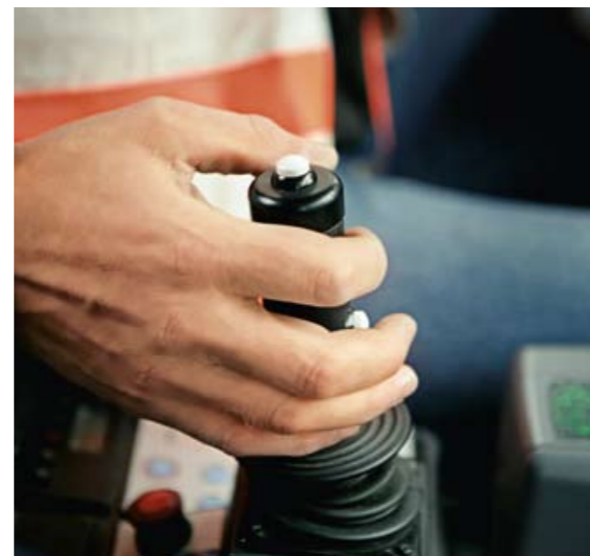
Mit dem kulissengeführten Joystick kontrollieren Sie alle Stellbewegungen – einfach und bequem
