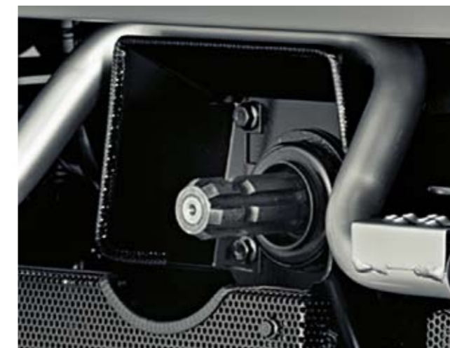
Direkt vom Motor angetrieben – die Frontzapfwelle für den Einsatz von Geräten mit hohem Leistungsbedarf
