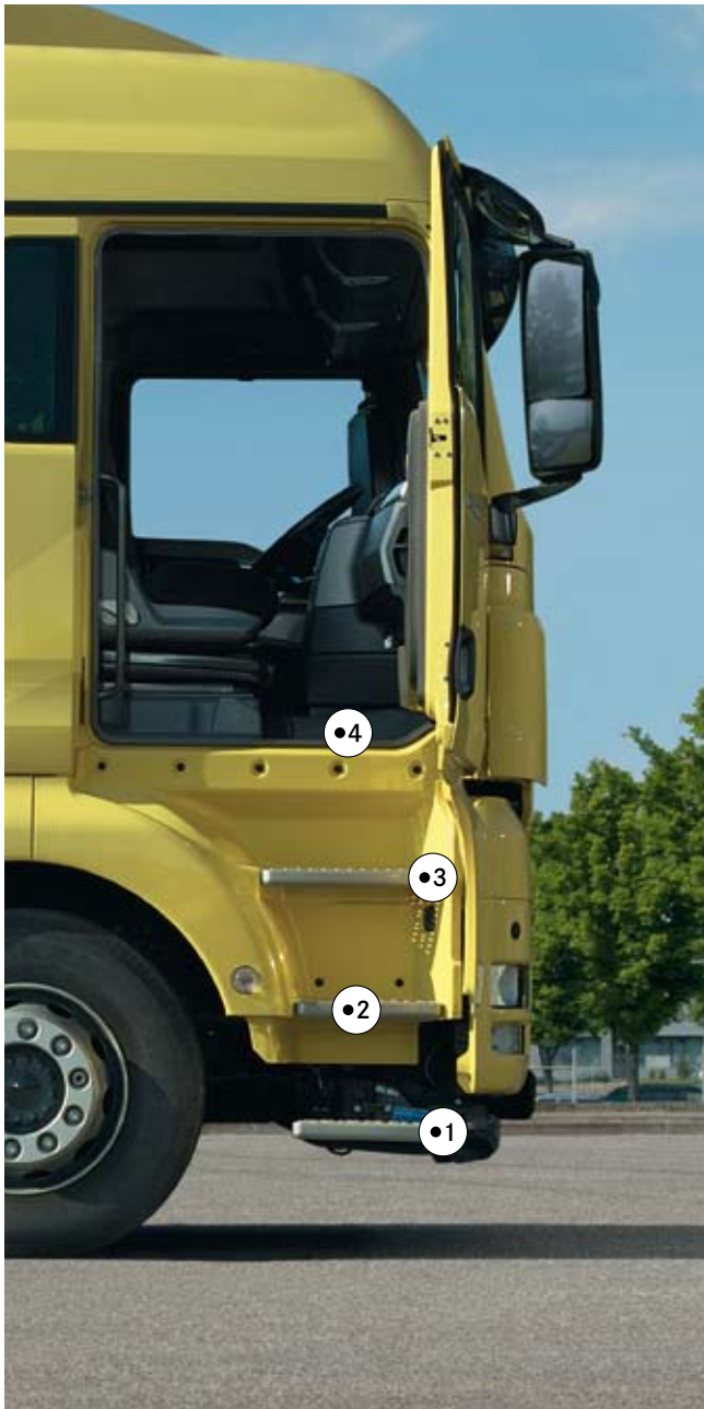
Konventionelles Fahrerhaus: Bei konventionellen Fahrerhäusern ist Klettern angesagt. Stufen in unterschiedlichen Tiefen (1-4) verlängern Arbeitsprozesse.
