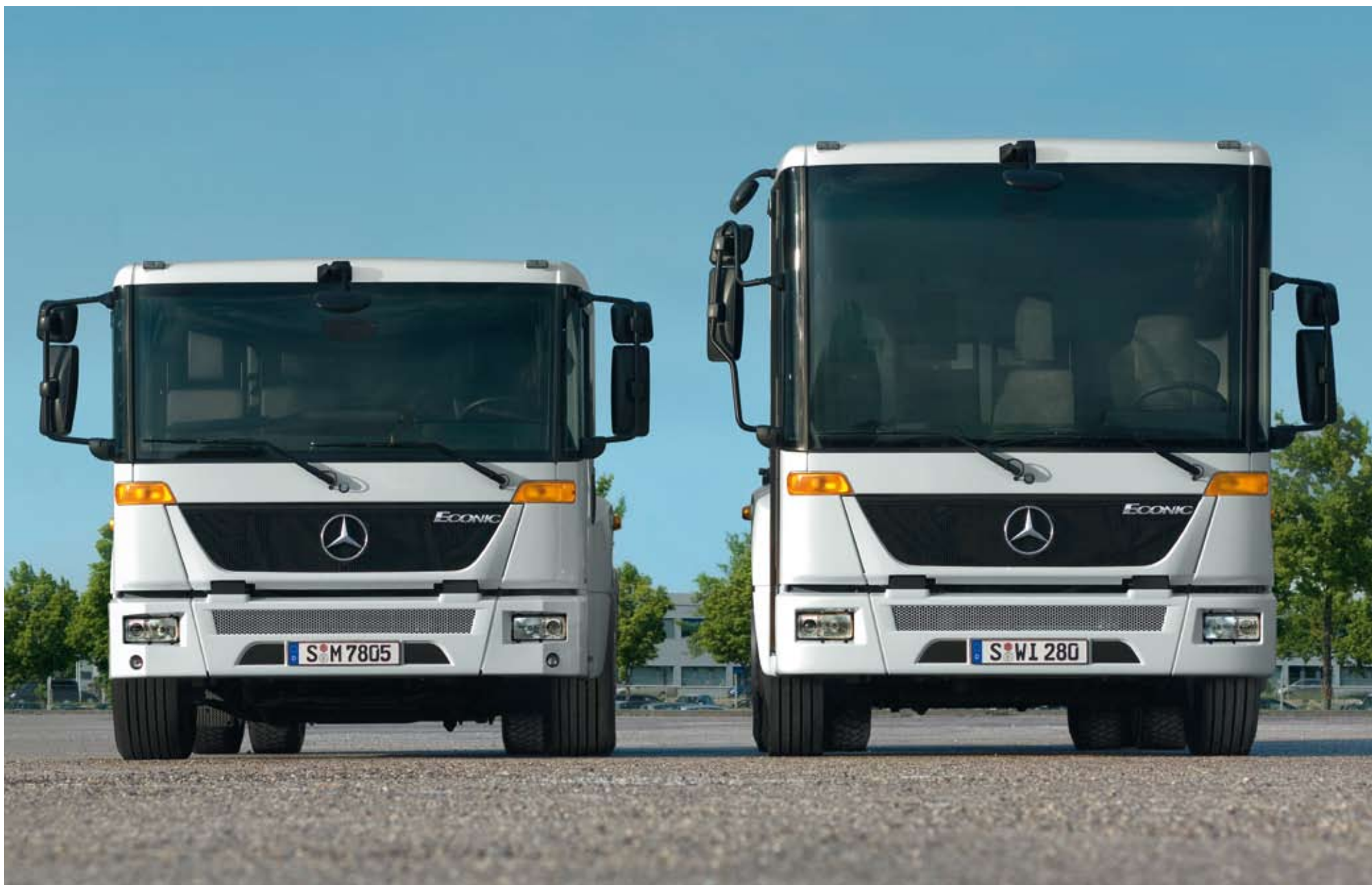
Fahrerhausvarianten: Das niedrige Fahrerhaus ermöglicht höhere Aufbauten, das hohe Fahrerhaus bietet mehr Komfort.
