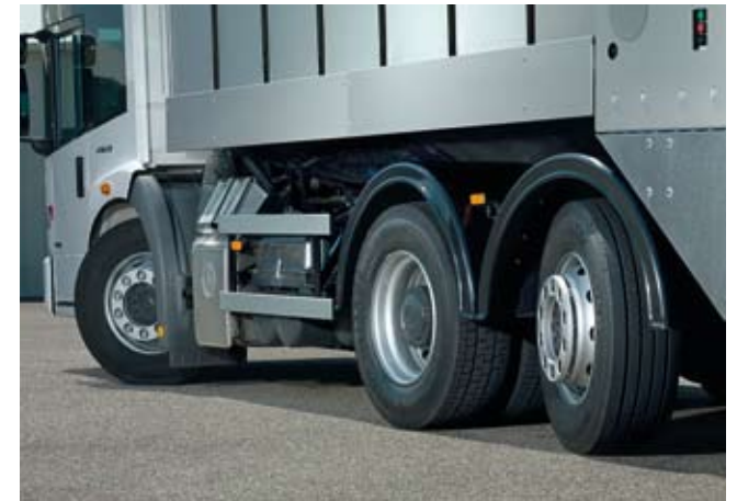
Vor- oder Nachlaufachsen: Mit der optionalen, elektro-hydraulisch gelenkten Vor- oder Nachlaufachse ist der Econic extrem wendig.
