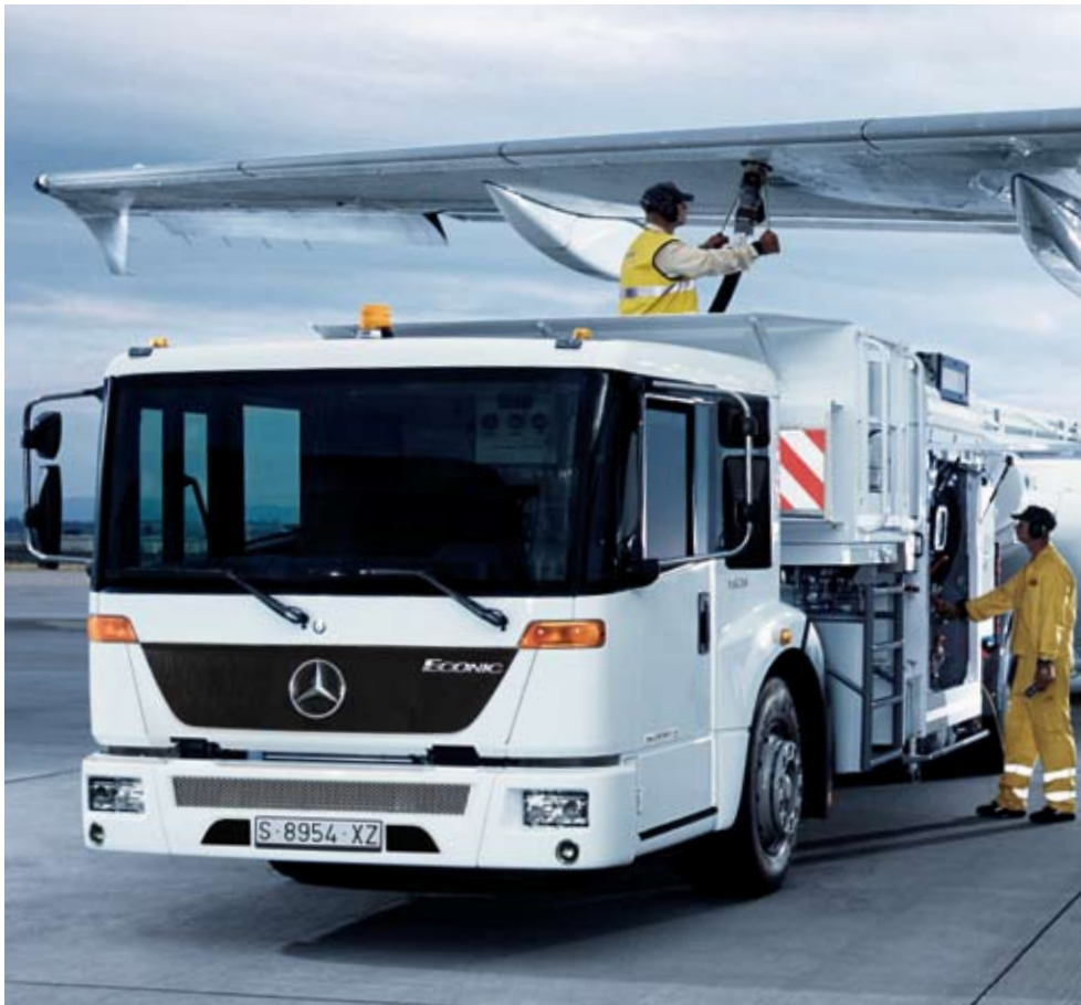
Econic Flugfeld-Tankwagen: dank aufbaufreundlichem Niederflrrahmen und niedrigem Schwerpunkt geradezu prädestiniert für den Flugfeld-Betankungseinsatz.
