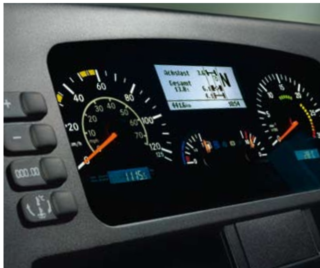
Instrumententafel: Die zentrale Achslastmesseinrichtung zeigt permanent den aktuellen Beladungszustand und das jeweilige Gesamtgewicht der einzelnen Achsen.
