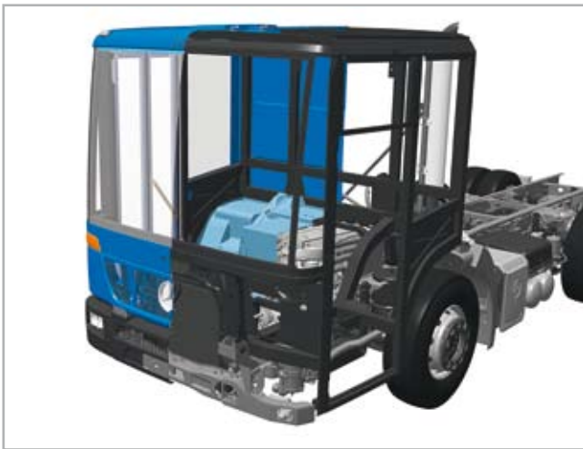
Alu-Space-Cage-Fahrerhaus: Die Fahrerhäuser des Eonic sind in Aluminium-Leichtbauweise gefertigt und erfüllen die europäische Crashtest-Norm ECE R29/2.
