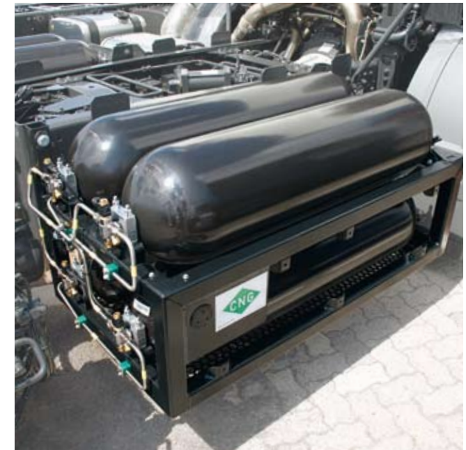
Hochdrucktanks: Die durch einen massiven Stahlrahmen geschützten Gasflaschen entsprechen ebenso wie Motor, Leitungen, Ventile etc. dem hohen Sicherheitsstandard ECE R110.
