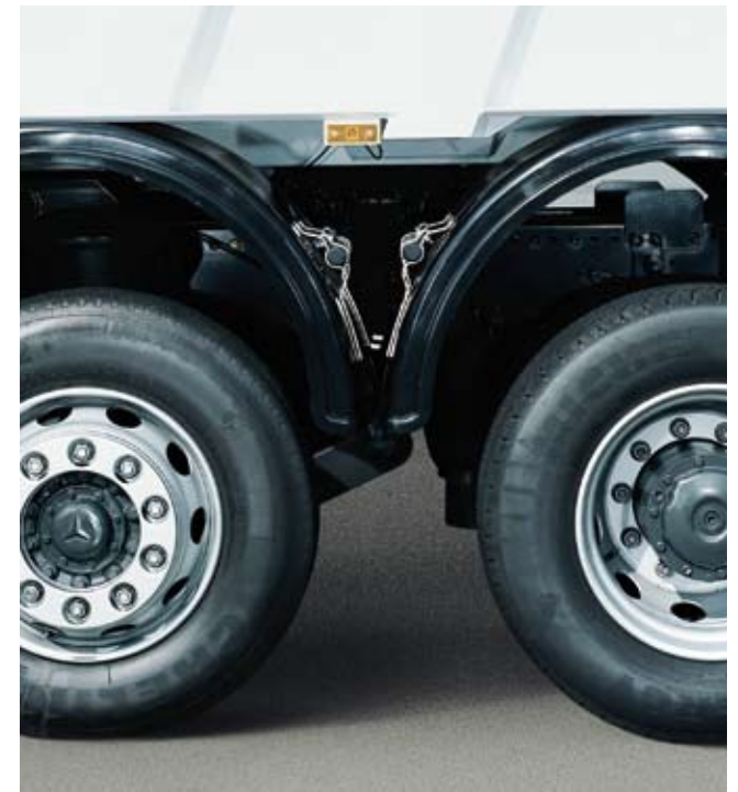
Hebe-/Senkfunktion: Mit der Hebe- und Senkfunktion kann der Econic je nach Variante und Einsatzzweck um bis zu 200 mm angehoben und um bis zu 60 mm abgesenkt werden.
