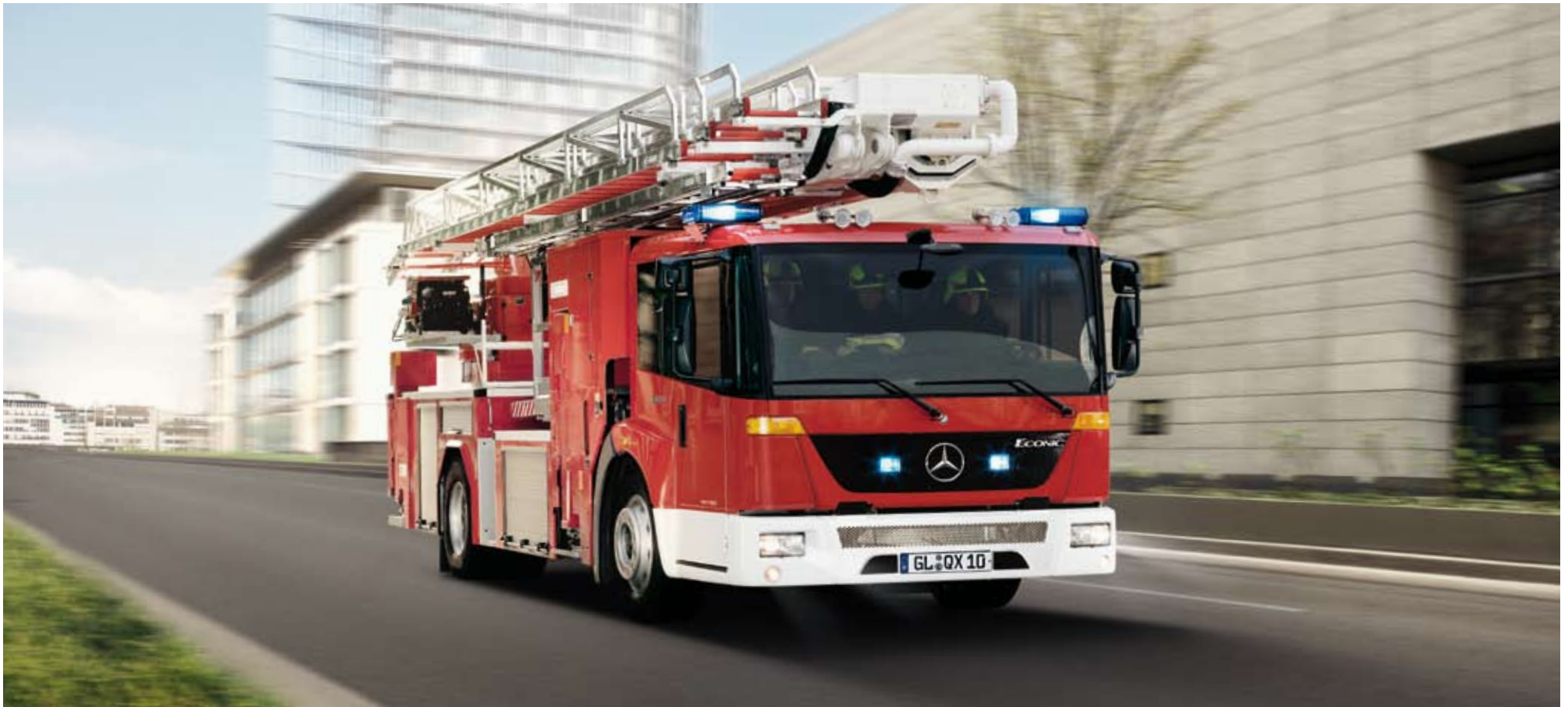
Das Eonic Drehleiterfahrzeug: mit nur drei Metern Gesamthöhe die optimale Voraussetzung, um auch bei niedrigen Unterführungen direkt und ohne Zeitverlust zum Einsatzort zu kommen.
