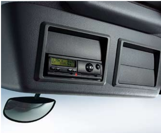
Vorrüstung für Kommunikationsgeräte: Vier DIN-Schächte im oberen Bereich der Windschutzscheibe bieten einen sicheren, optimal zugänglichen Platz für Tachograph, Toll Collect oder FleetBoard.
