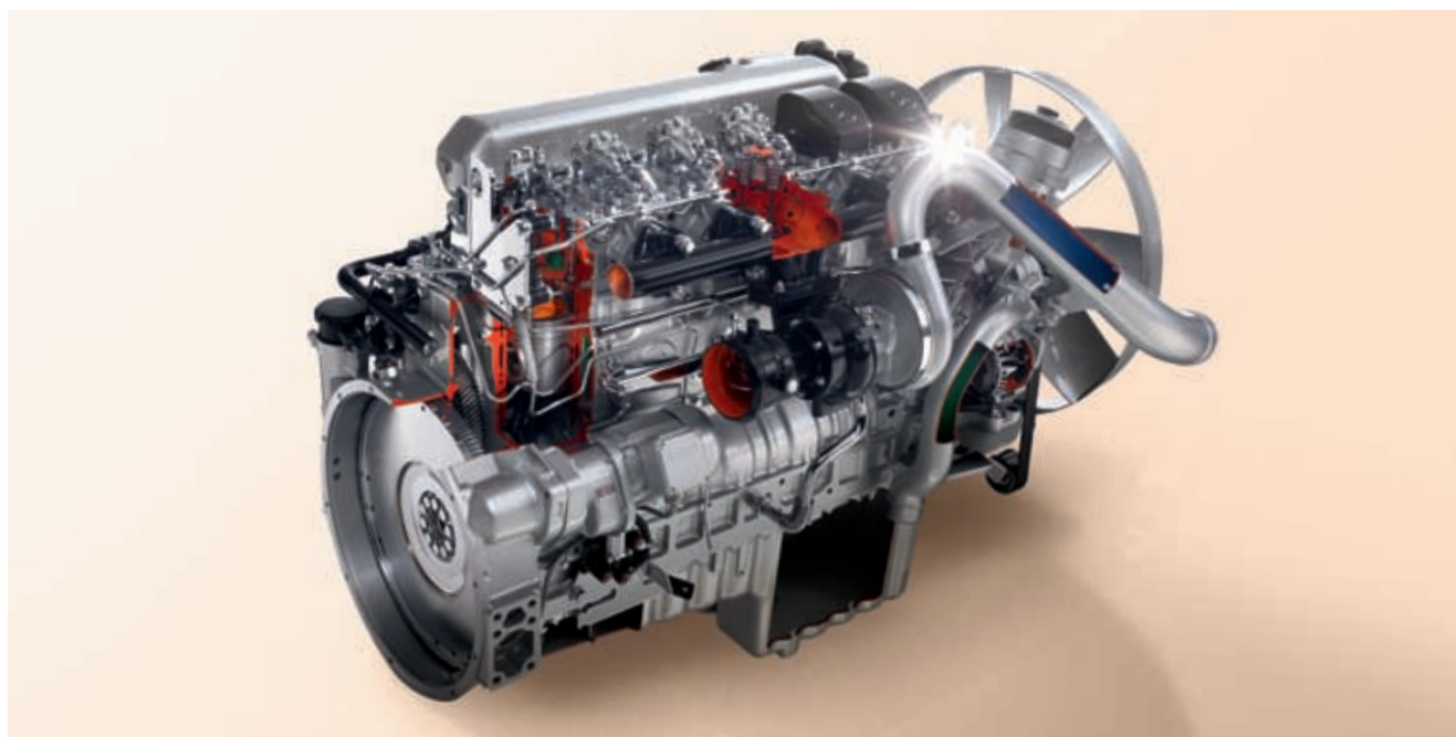
Jede Menge Leistung für 3- und 4-achsige Kipper und Betonmischer: Die 6-Zylinder-Reihenmotoren mit 12 l Hubraum stellen je nach Ausführung zwischen 265 kW (360 PS) und 315 kW (428 PS) zur Verfügung. Für die Baustelle heißt das: viel Kraft dort, wo sie gebraucht wird.
