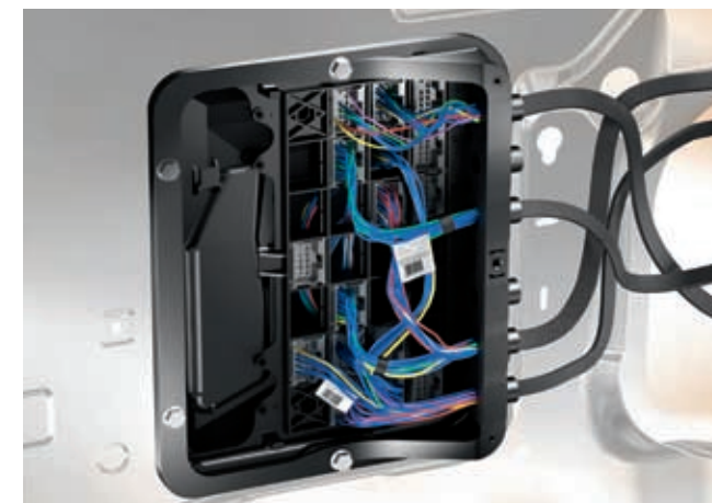
Die Aufbauhersteller-Schnittstelle ermöglicht Aufbauherstellern einen schnellen, unkomplizierten Zugriff auf die elektrischen Systeme des Atego. Das spart Zeit und Kosten und vereinfacht die »Kommunikation« zwischen Fahrzeug und Aufbau.
