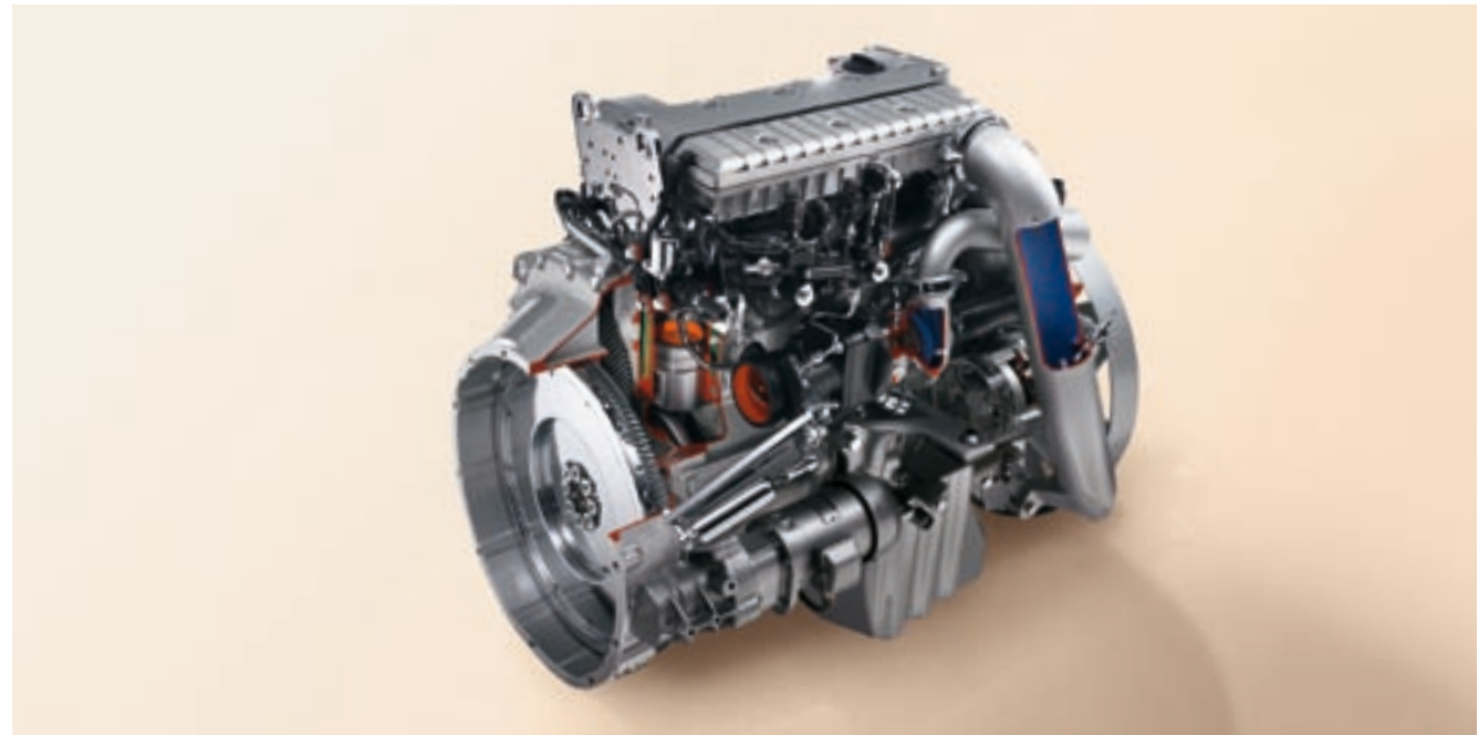
4-цилиндровый рядный двигатель с рабочим объемом 4,8 л имеет мощность 160 кВт (218 л.с.), которую обычно ожидают от 6 цилиндров. Еще одно преимущество двигателя: он приблизительно на 100 кг легче, чем 6-цилиндровый двигатель такой же мощности.
