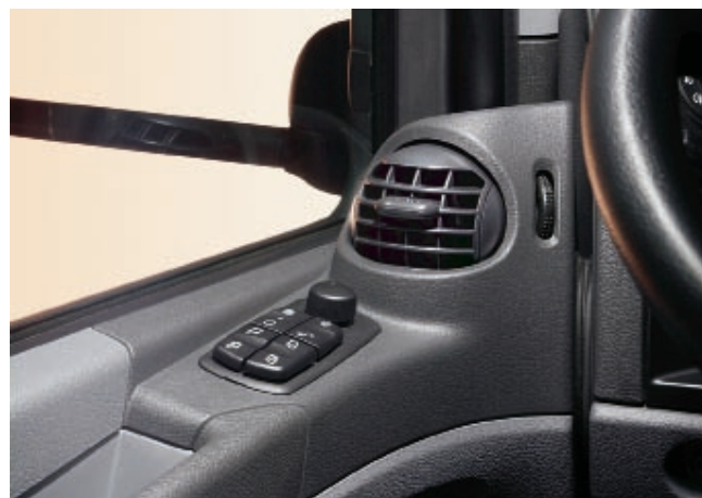
Над панелью управления двери находятся переключатели для изменения положения и для нагрева зеркала, а также для управления стеклоподъемниками и предоставляемыми в качестве опции центральным замком и системой привода замков. Сферический вентиляционный дефлектор повышает безопасность, предотвращая запотевание боковых стекол.
