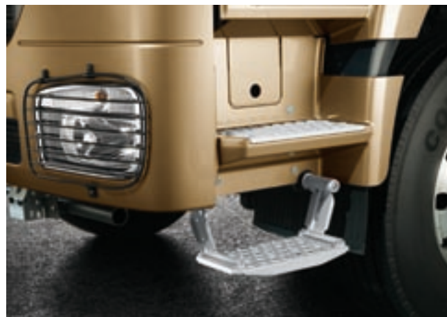
Автомобили для обслуживания строительных работ и полноприводные автомобили Ахог в серийном варианте имеют с обеих сторон подвижную нижнюю ступеньку. При контакте она отклоняется в продольном и поперечном направлении, что позволяет избежать ее повреждения.
