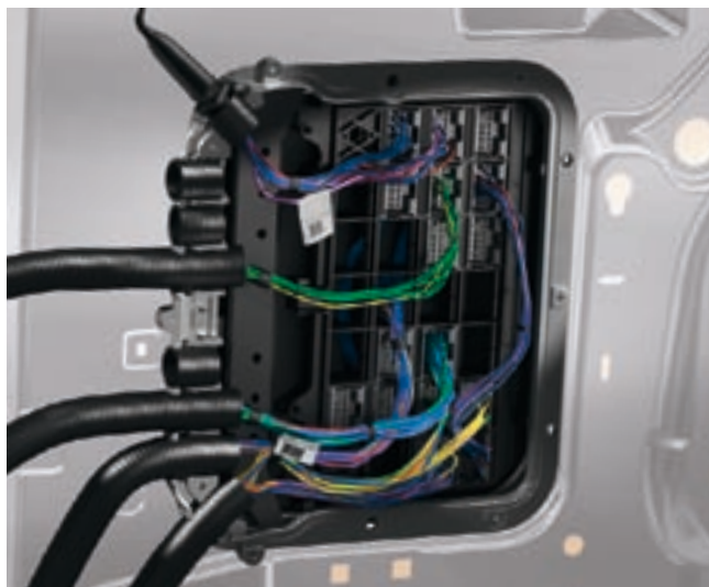
Специальный параметрируемый модуль (PSM) позволяет осуществлять внешнее управление функциями автомобиля, а также обмен данными между электроникой автомобиля, навесным оборудованием и платформами.
