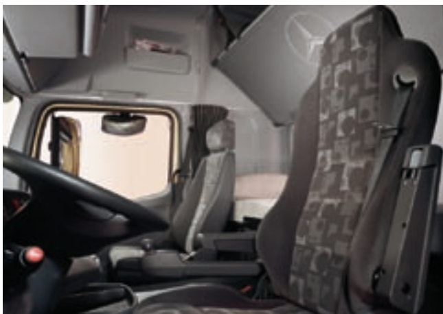
Стандартное сиденье с пневмоподвеской для водителя в автомобилях Ахог для строительных работ принадлежит к серийному оборудованию.
