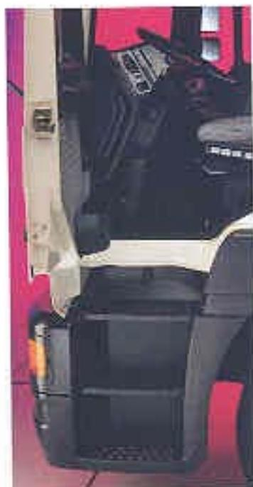
Aufstapler: Dreistufig und bequem aus rutschsicherem Lochblech; entsprechen in den Bauhöhen den unterschiedlichen Fahrerhausvarianten, sind bei geöffneter Tür beleuchtet.
