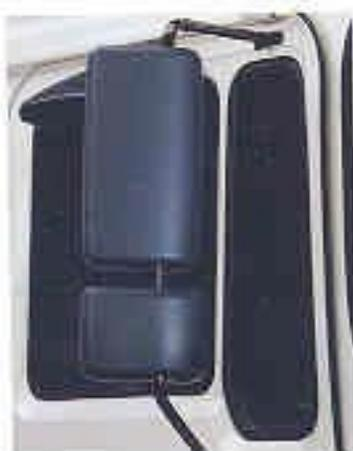
Blick zurück in Form: Größere Sichtfelder bei den aerodynamisch optimierten Außenspiegeln; die verstärkte Befestigung hält sie auch auf holprigen Straßen ruhig.
