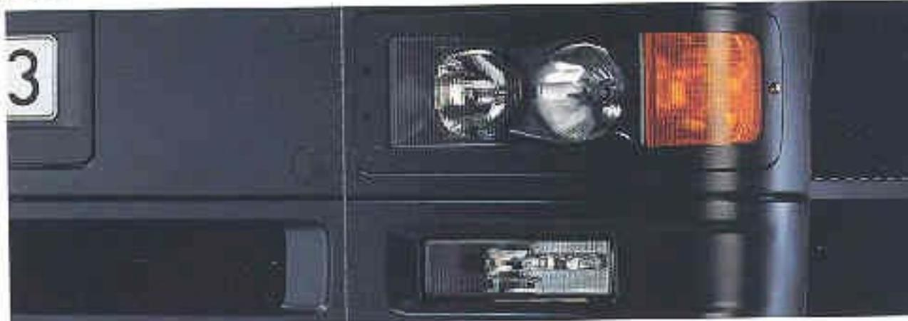
aus SMC gefertigt, stoßabsorbierend und recyclingfähig. Hinter der aerodynamischen Bugschürze befindet sich der Unterfahrschutz, ein wichtiger Beitrag zur passiven Sicherheit. Das Außenspiegelsystem bietet größere Sichtfelder als je zuvor, ist elektrisch von innen verstell- und beheizbar. Und dann der dreistufige Einstieg: Nie ist ein Fahrer leichtfüßiger und sicherer „aufgestiegen“!
