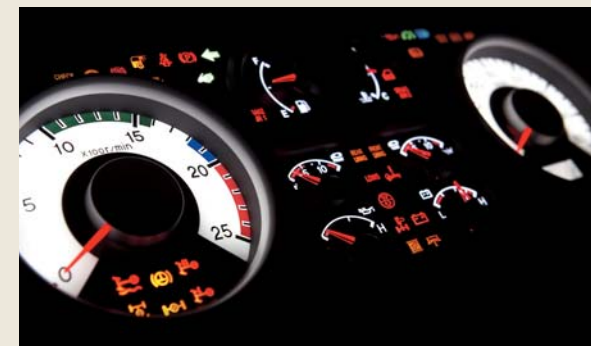
항공기 타입 중앙집중식 계기판 최첨단 디자인의 항공기 타입 중앙집중식 계기판은 LED조명을 적용하여 시인성 및 조작성능이 향상 되었습니다.
