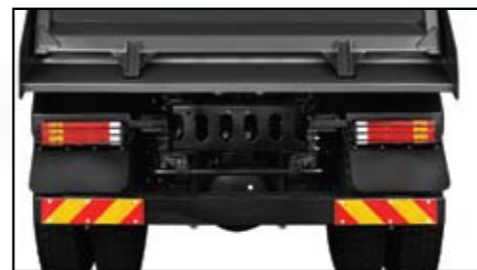
리어 프로텍터 : 후면의 차량으로부터 안전성을 확보하기 위하여 시인성을 보강한 리어 프로텍터
