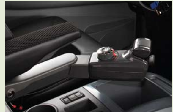
팔걸이형 자동 변속기 T/M 레버 : 팔걸이에 레버가 위치해 있어 장거리 운전에도 피로하지 않으며 실내 공간 이동에 불편함이 없도록 상하좌우 각도 조절식으로 설계됨
