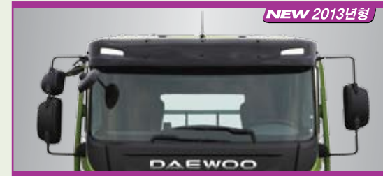
전동 조절식 아웃사이드 미러 : 전동식으로 편리하게 미러 각도 조절이 가능하며 열선이 내장되어 있어 우천시 시야 확보를 도와줌
