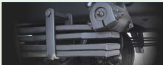
후축 테이퍼 스프링: 길이가 긴 고탄성 테이퍼 스프링을 적용하여 중량 적재시나 험로 운행시 충격을 최소화하고 승차감 향상 및 차량 내구성을 우수하게 해줌
