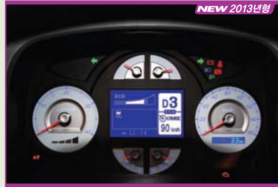
대형 LCD 계기판 : 차량 주행 정보를 모두 표시해 주어 차량의 경제적인 운행을 가능하게 함 (에코드라이빙 시스템 / 디지털시계 적용)
