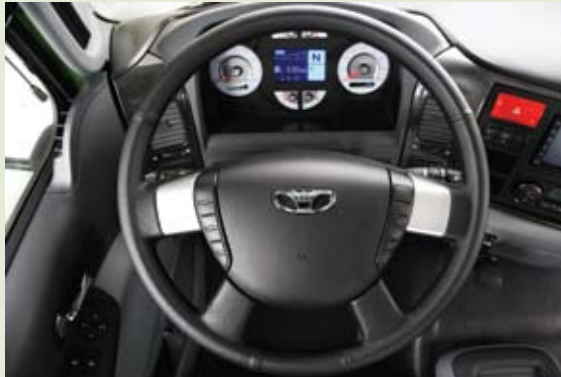
고급 가죽 스티어링 휠 : 운전자의 체형에 맞게 조절가능한 틸팅 및 텔레스코픽 기능과 리모트 컨트롤 키가 내장되어 있어 조작이 편리함
