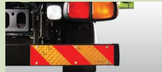
알루미늄 리어프로텍터: 가볍고 고급스러운 느낌의 알루미늄 재질로 후면의 차량으로부터 안전성을 확보
