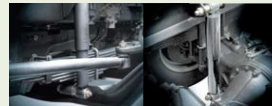
전축 & 후축 속업쇼버: 프론트 & 리어 액슬 충격을 최소화시켜 주는 복동식 속업쇼버를 적용하여 승차감을 향상
