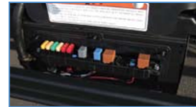
보조 안전 퓨즈박스 : 과부하가 많이 걸리는 퓨즈를 따로 모아서 배터리의 측면에 부착 시켰습니다.
