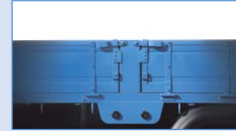
2 - 게이트 타입 센터바 : 내구성이 우수한 2-Gate 타입 센터바를 적용하여 중량물 적재시에도 변형이 적습니다.
