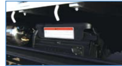
MF 배터리 : 전해액 보충이 필요 없는 MF 배터리를 적용 하였습니다.(150A).
