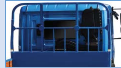
스틸타입 프론트 가드 : 내부의 재질을 철판(Steel)으로 적용하여 어떠한 화물을 실어도 적재함 변형이 적고 내구성이 우수합니다.
