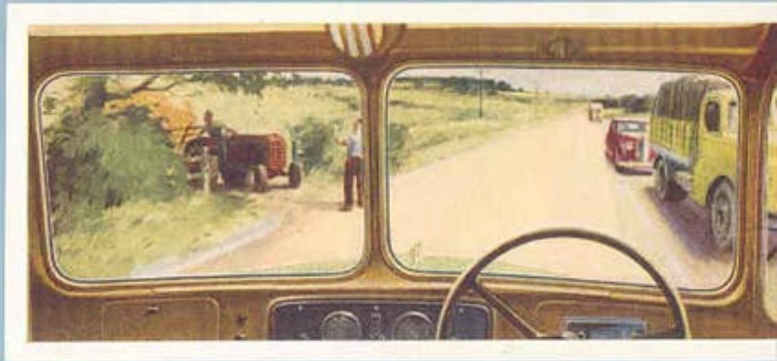
Het uitzicht van de chauffeur door deze grote voorruit is zeer goed. De voorruit is scharnierend bevestigd, zodat zij geopend kunnen worden indien dit wordt gewenst.
