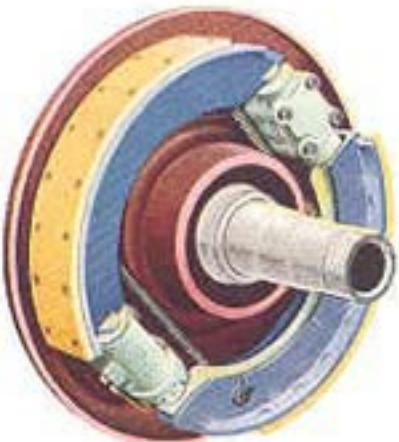
Alle Austin trucks zijn voorzien van hydraulische Lockheed remmen. Grote remoppervlakken verzekeren snel stoppen bij normale condities en noodgevallen. De 6½ tons chassis zijn voorzien van dubbele remcylinders in de voorwielen. Het remstelsel wordt d.m.v. vacuum gekrachtigd.
