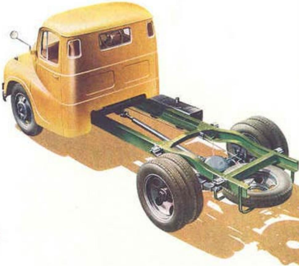
De Austin chassis zijn te leveren met en zonder cabine, zodat iedereen een huifbak naar eigen wensen hierop kan later aanbrengen. Austin levert bovendien het 1½ tons trekkerchassis, waarschijnlijk verschillende oplegger combinaties mogelijk zijn. Bovenstaande afbeelding toont het Austin 4½ tons chassis met cabine voorzien van de 4 liter kopklepmotor.
