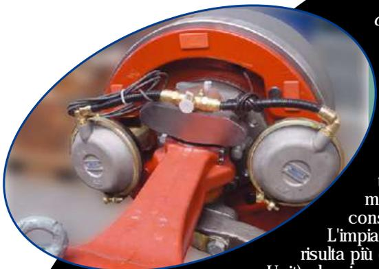
La gamma HD7/c adotta freni a tamburo con una importante novità tecnica: due rotocamere (Duo Duplex) per ciascuna ruota, per bilanciare meglio la frenata e rendere più uniforme l'usura delle guarnizioni con conseguente aumento della durata (+40%).
