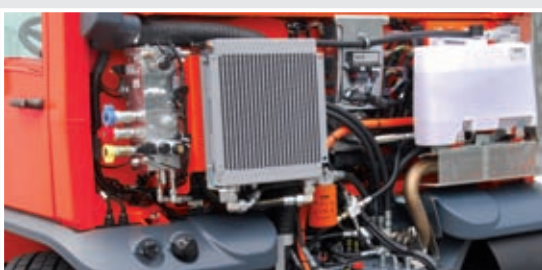
Servicefreundliche Kabinenrückseite mit serienmässigem Ölkühler
